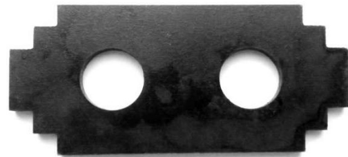
Рис. 3. Области зносу молотка дробарки КДУ.
