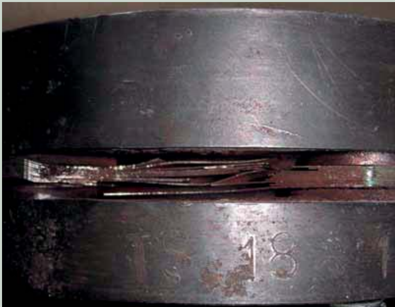
Рис. 2. Руйнування пакету пружних елементів в наслідок фреттинг-корозії
