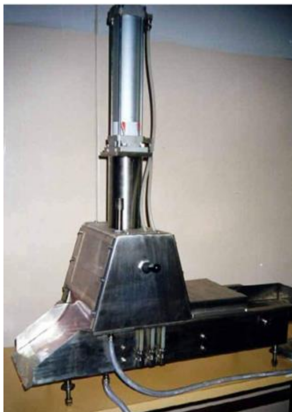
Рис. 6 Пневматичний ін'єктор-автомат Я5-ФШ1Л (розробка фахівців ППР НААН)
