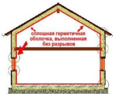
Рис. 6. Суцільна герметична оболонка, виконана без розривів
