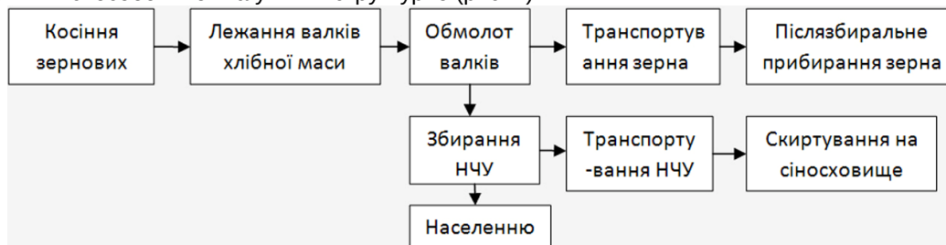
Рисунок 1 - Структурна схема роздільного способу збирання зернових культур
