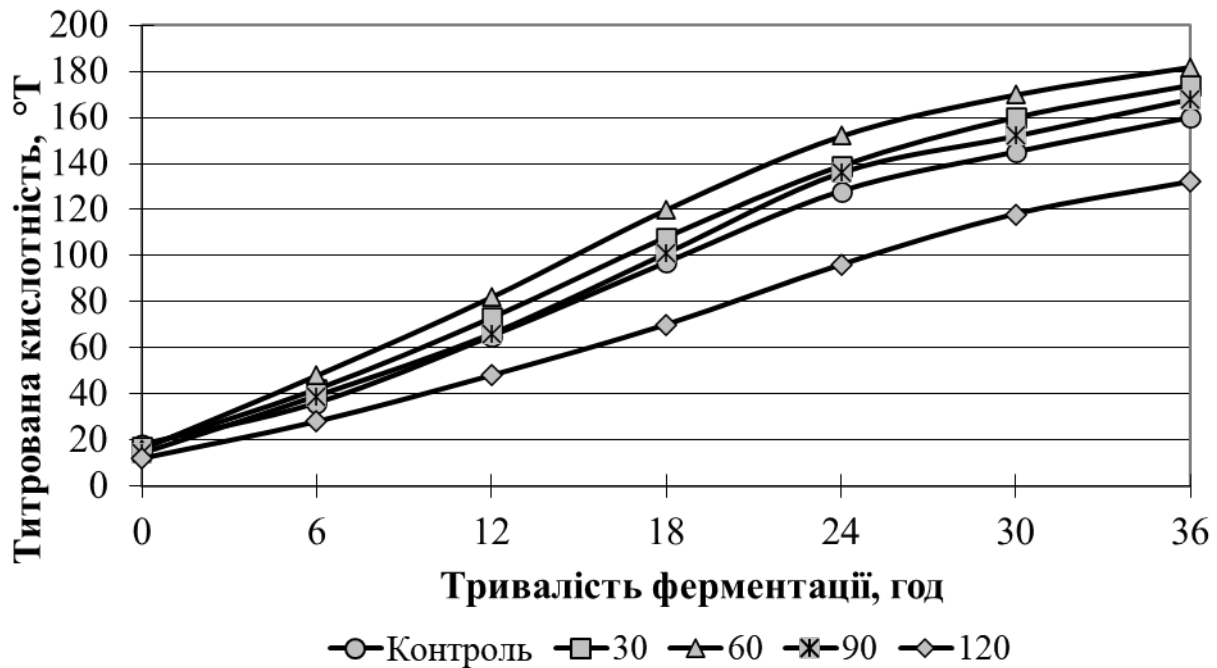
Рисунок 5 – Динаміка ферментації молочної сироватки, обробленої в розрядній камері зі струмопровідним шаром гранул Mg, в порівнянні із необробленою молочною сироваткою
