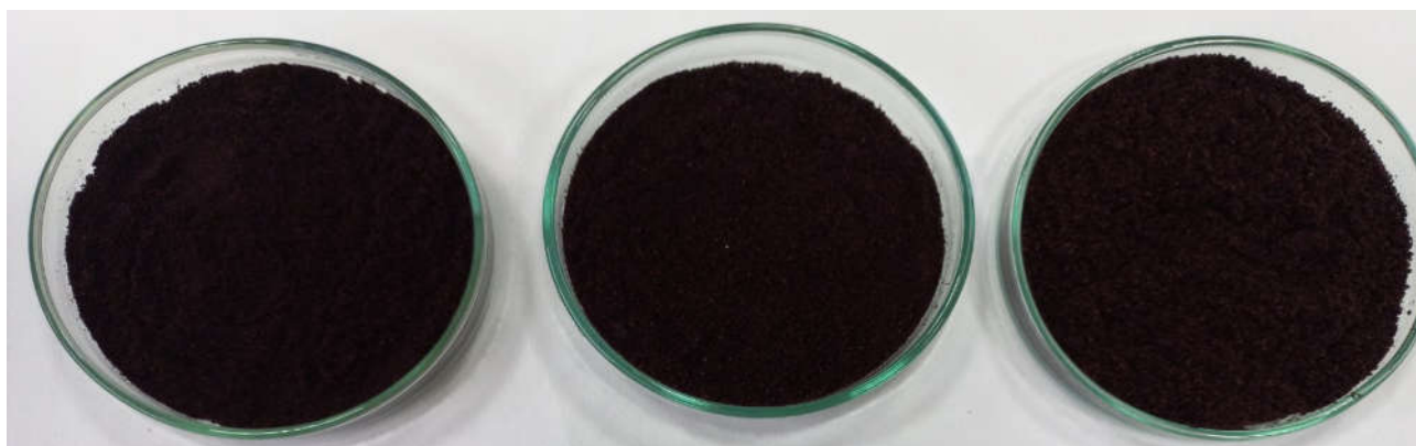
а б в Рис. 1 – Порошки із похідних переробки ягід Sambucus nigra : а – фракція отримана на ситі №0,07; б – фракція отримана на ситі №0,016; в – фракція отримана на ситі №0,045
