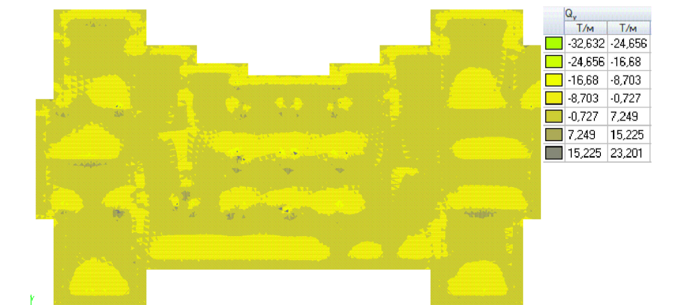
Напруження в конструкції по Qy (після реконструкції)
