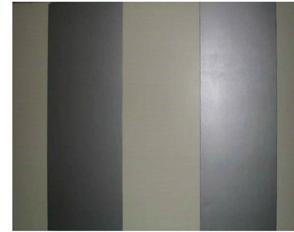
Панелі, де захисно-опоряджувальний шар – сталь оцинкована з поліестеровим покриттям
