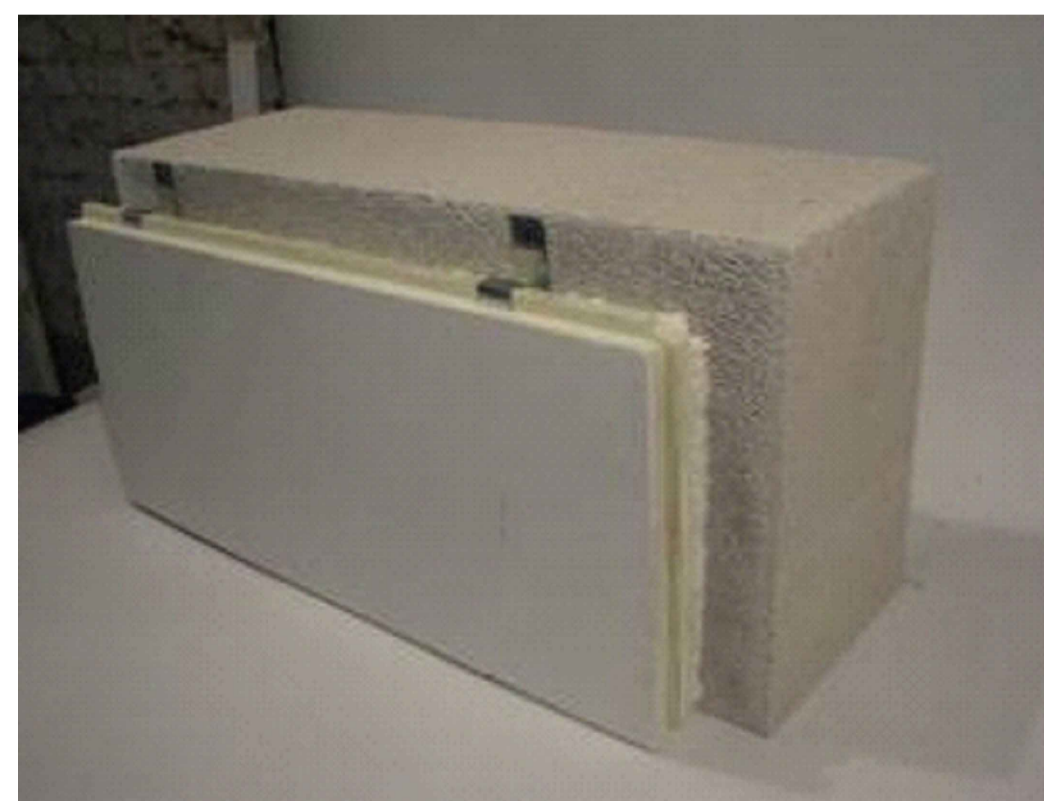
Фрагмент стіни із піноблоків утепленої панелями «Анталія»
