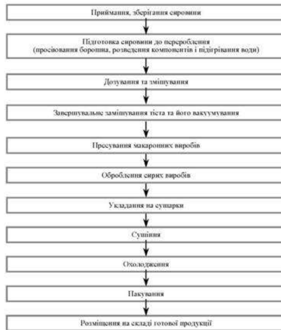
Рис. 2. Узагальнена схема виробництва макаронних виробів.
