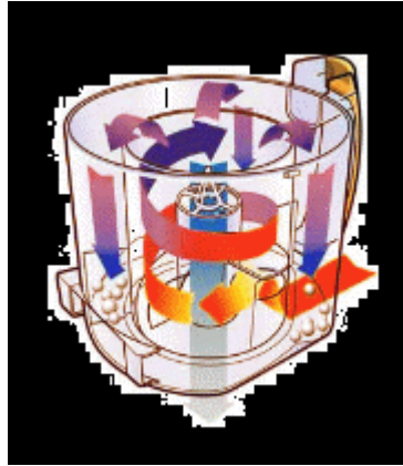
Рис. 4. Принцип роботи пилососу циклонного типу
