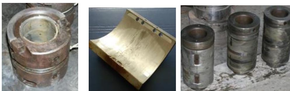
Рисунок 5.3 – Руйнування бабітового шару ПК:
