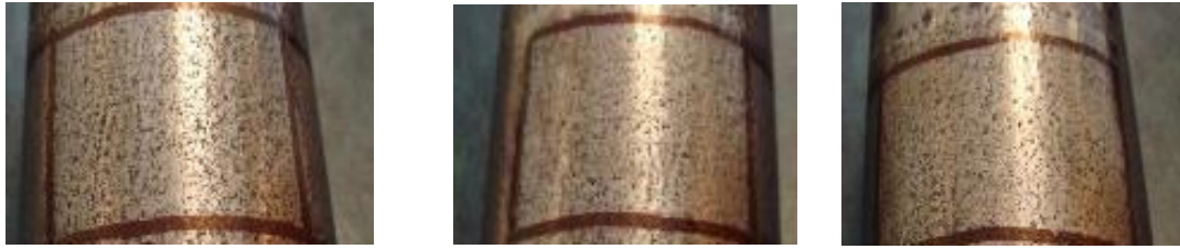
Рисунок 3.5 – Зразок зі сталі 40X після ЕІЛ а-сріблом, б-міддю та в-нікелем.
