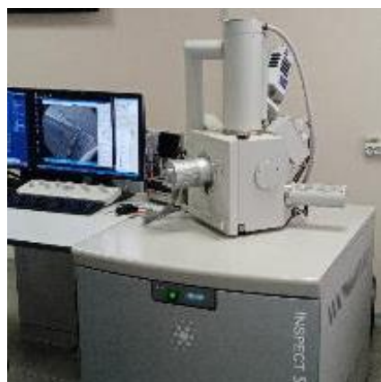
Рисунок 3.7 – Вигляд електронного мікроскопа SEO-SEM Inspect S50-B.
