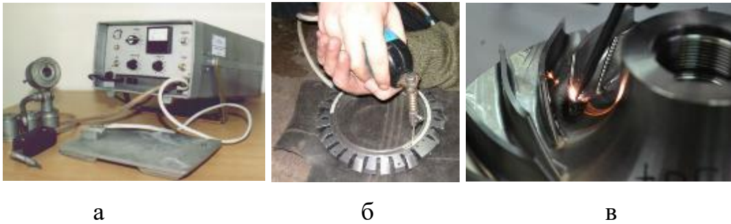
Рисунок 3.3 – Установка моделі «ЕІЛ-8А» (а) для проведення ЕІЛ плоских (б) і криволінійних (в) поверхонь деталей.
