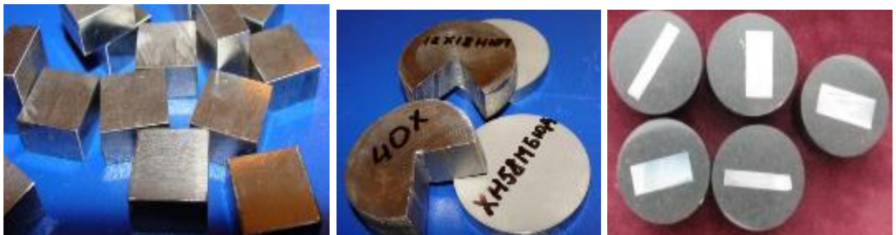
Рисунок 3.6 – Зразки і шліфи для дослідження параметрів якості поверхневих шарів деталей.
