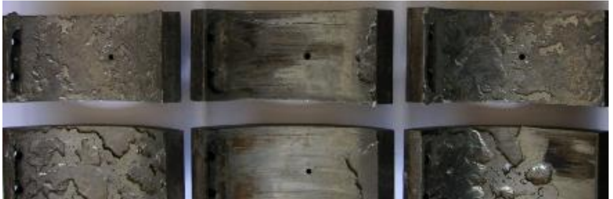
Рисунок 1.6 - Руїнування бабітового шару вкладишів ПК.
