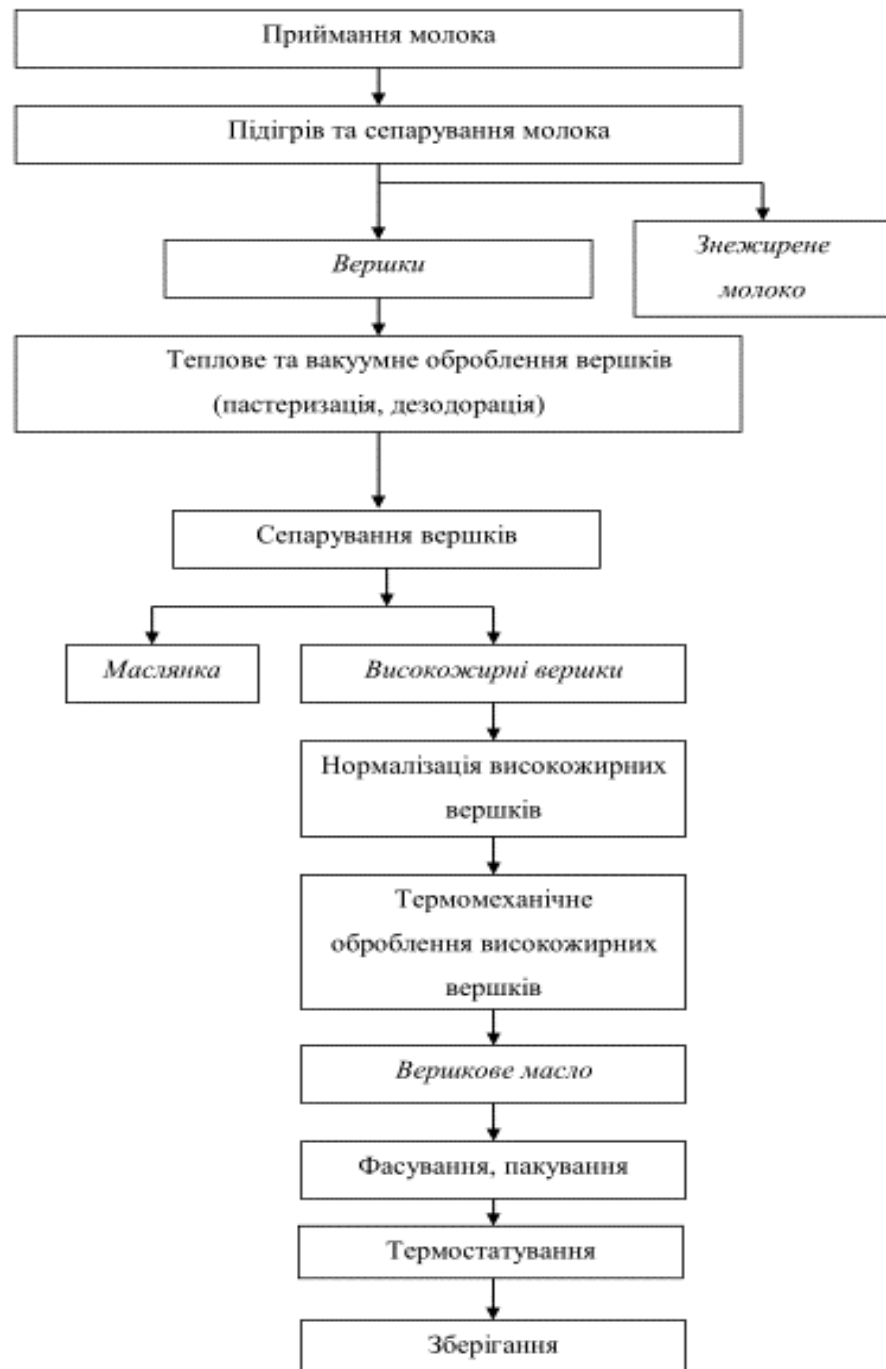
Рисунок 3.1 – Апаратно-технологічна схема переробки молока сирого для отримання вершкового масла та маслянки
