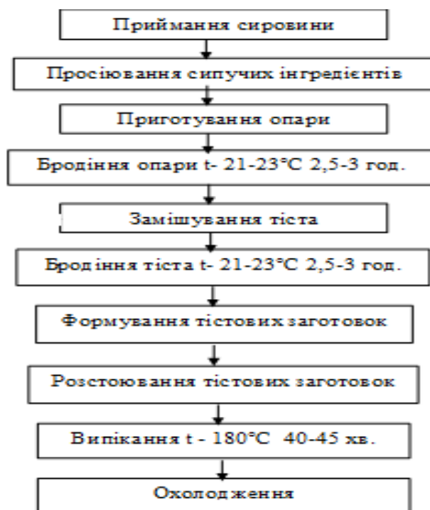
Рис.1.1 – технологічна схема виробництва піци «Пепероні»
