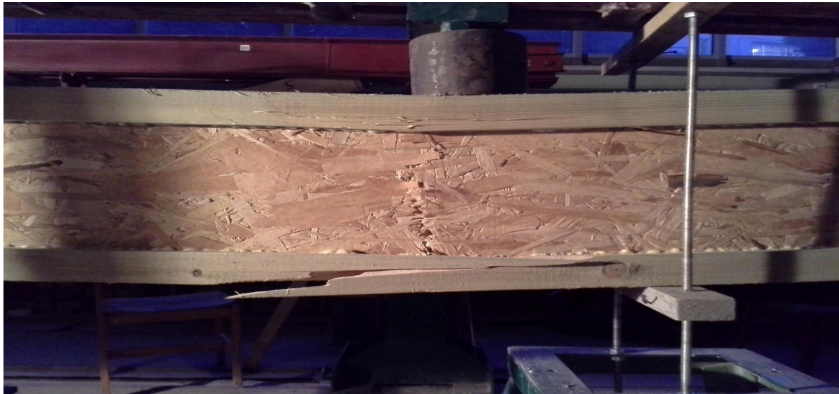
Фото 6. Місце руйнування стінки та полицок балки Б-6 ( P=2300\text{кгс} ).
