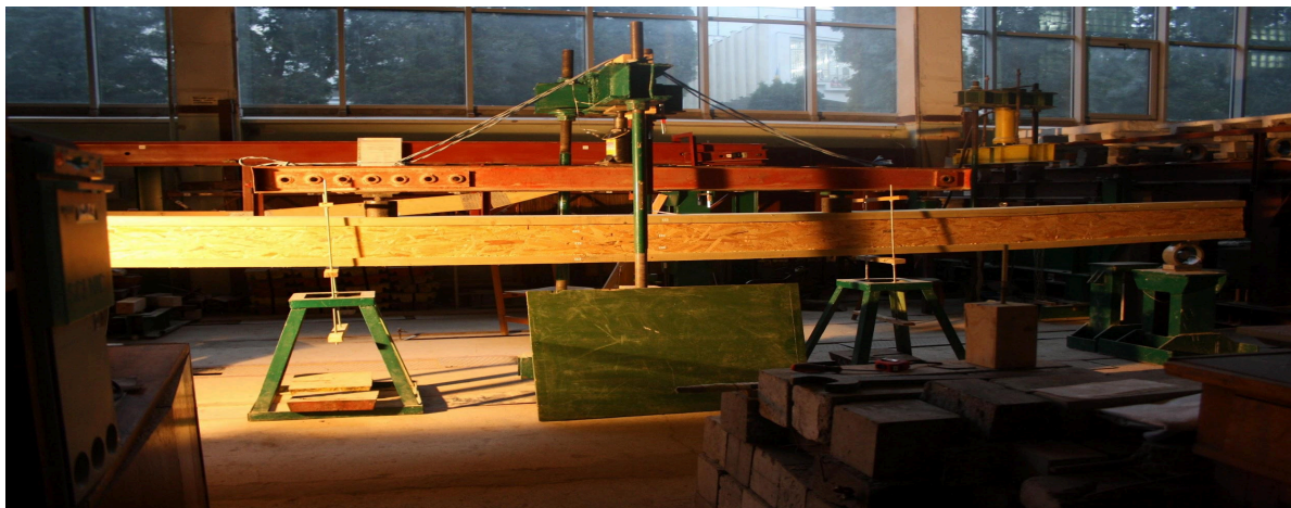
Фото 4. Вигляд балки Б-6 після руйнування.
