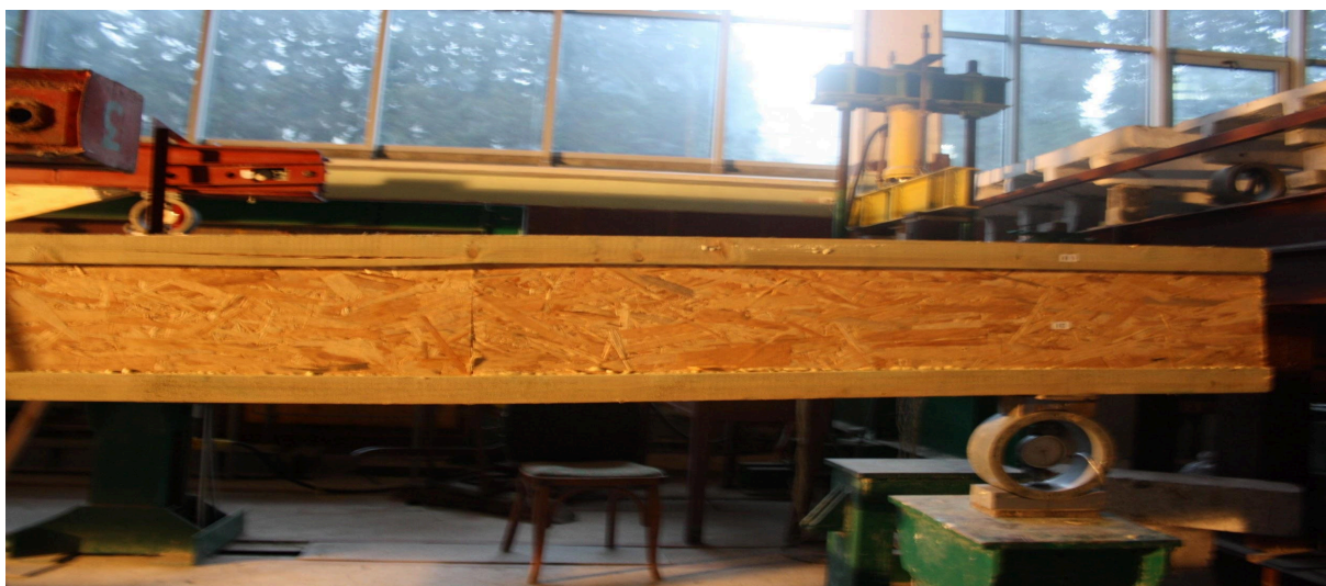
Фото 5. Місце руйнування полички балки Б-6 в стиснутій зоні (P=1850кгс).
