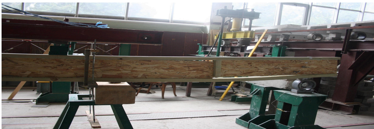
Фото 3. Місце руйнування стінки балки Б-5.
