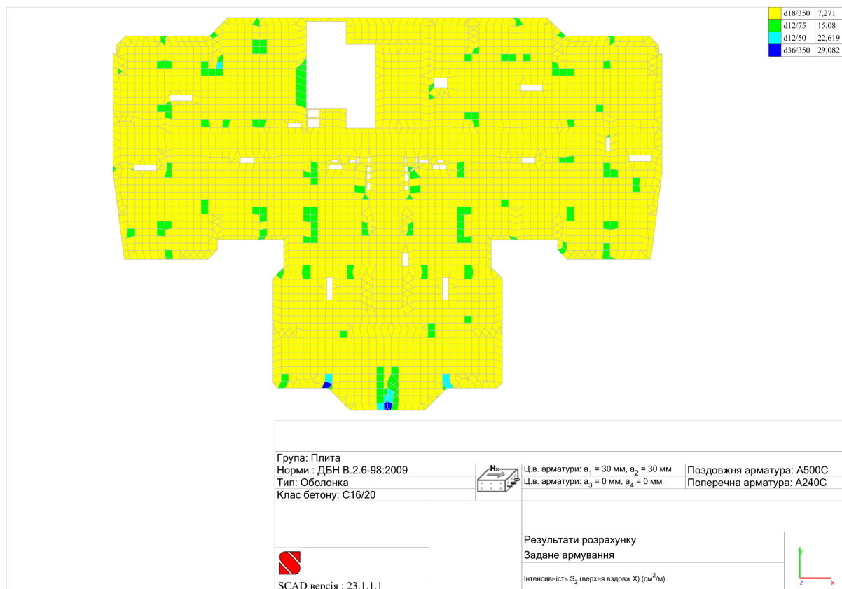
Рис.2.3.15. Схема перекриття із зазначенням інтенсивності армування верхньої зони плити вздовж осі X
