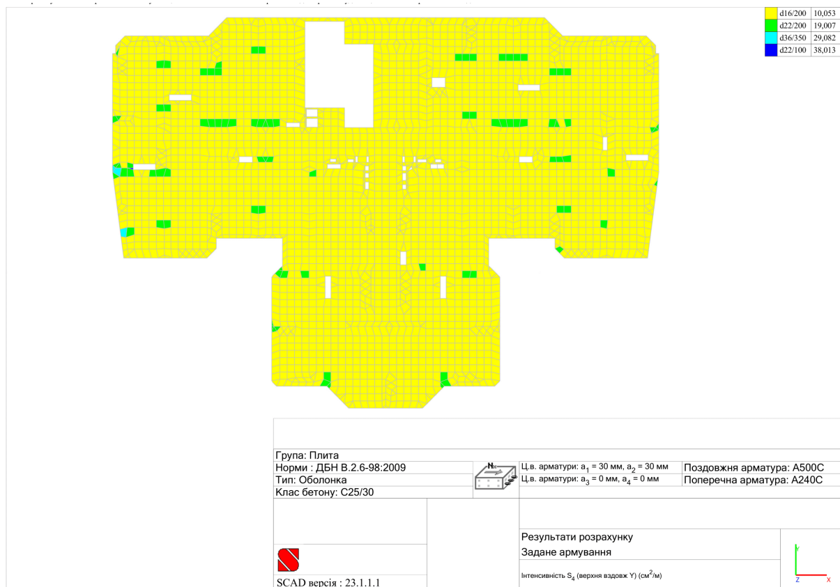
Рис.2.3.34. Схема перекриття із зазначенням інтенсивності армування верхньої зони плити вздовж осі Y
