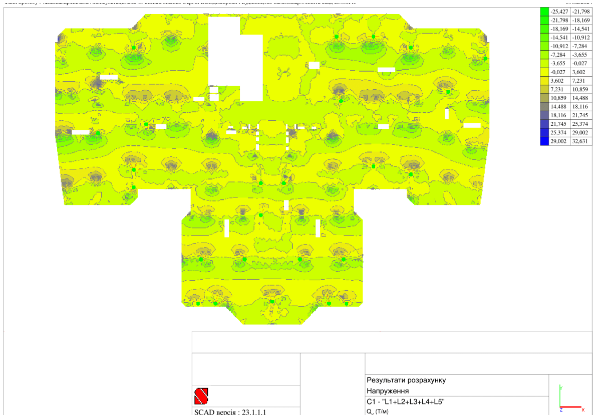
Рис.2.3.11. Схема перекриття із зазначенням величин зусиль поперечної сили Q_x відносно осі X
