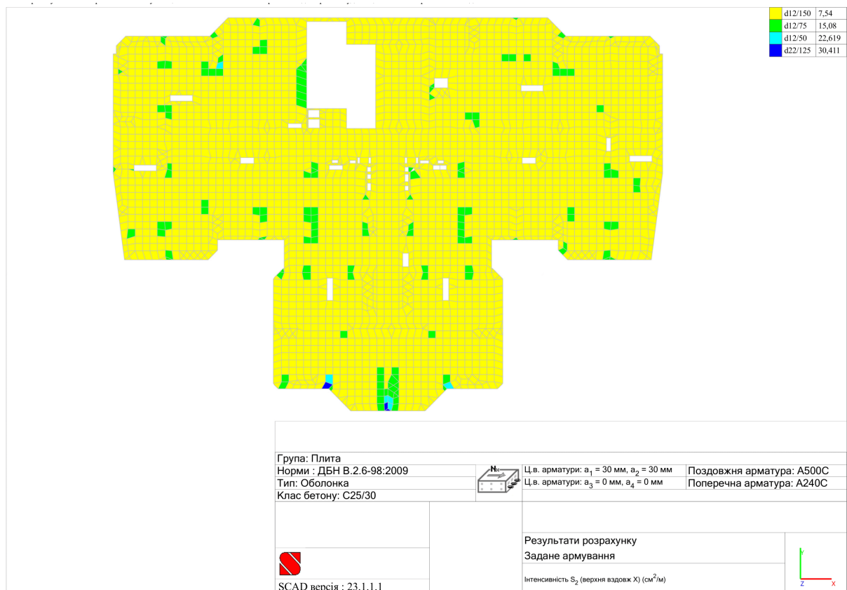
Рис.2.3.33. Схема перекриття із зазначенням інтенсивності армування верхньої зони плити вздовж осі X
