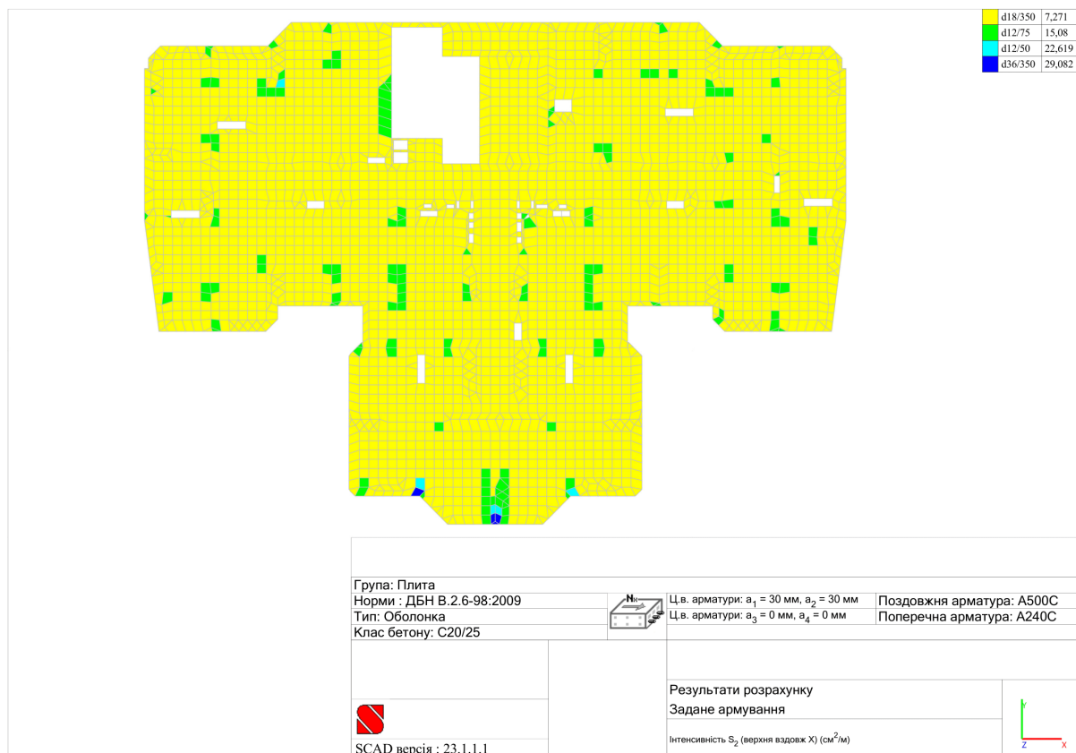
Рис.2.3.24. Схема перекриття із зазначенням інтенсивності армування верхньої зони плити вздовж осі X
