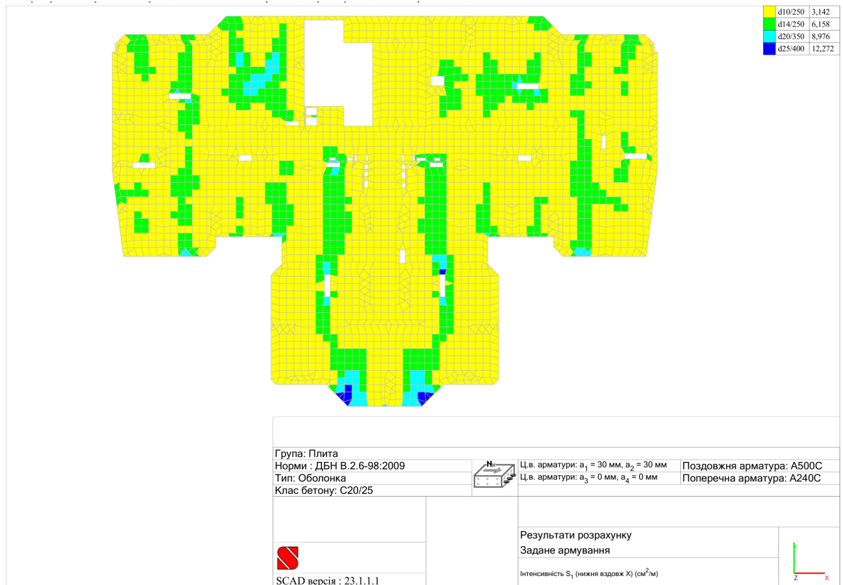
Рис.2.3.22. Схема перекриття із зазначенням інтенсивності армування нижньої зони плити вздовж осі X
