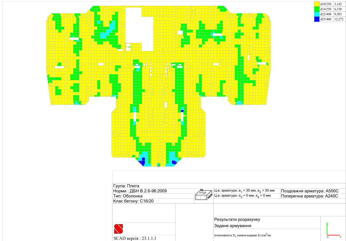
Рис.2.3.13. Схема перекриття із зазначенням інтенсивності армування нижньої зони плити вздовж осі X
