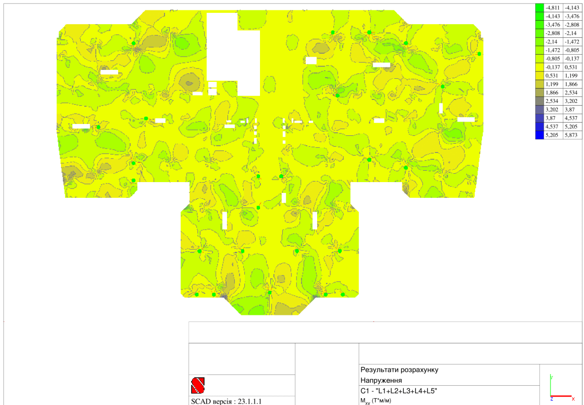
Рис.2.3.10. Схема перекриття із зазначенням величин згинальних моментів M_{xy} відносно осей X та Y
