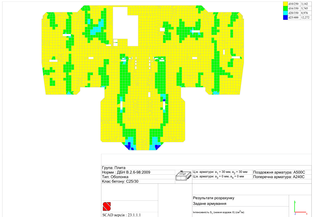
Рис.2.3.31. Схема перекриття із зазначенням інтенсивності армування нижньої зони плити вздовж осі X
