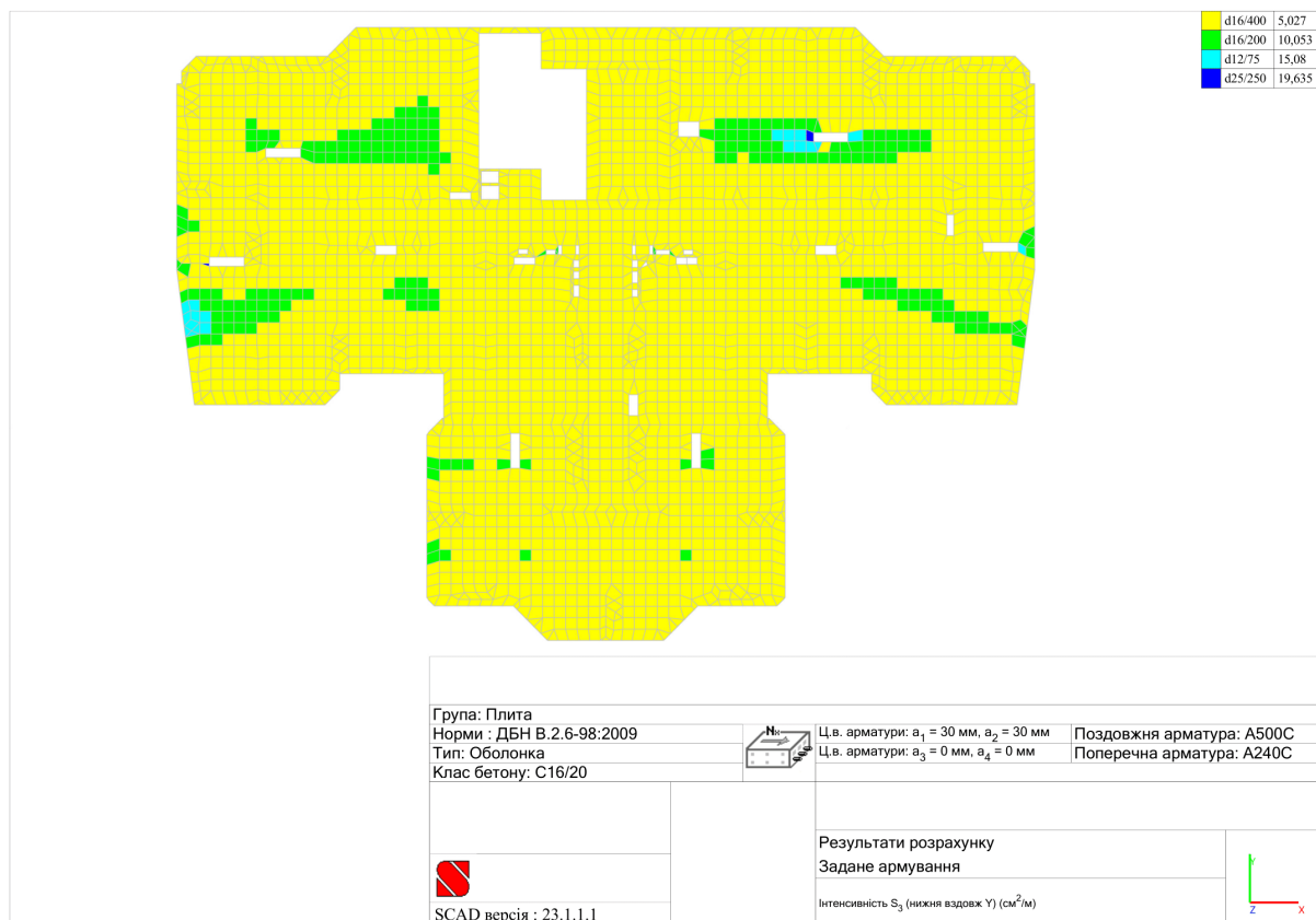
Рис.2.3.14. Схема перекриття із зазначенням інтенсивності армування нижньої зони плити вздовж осі Y
