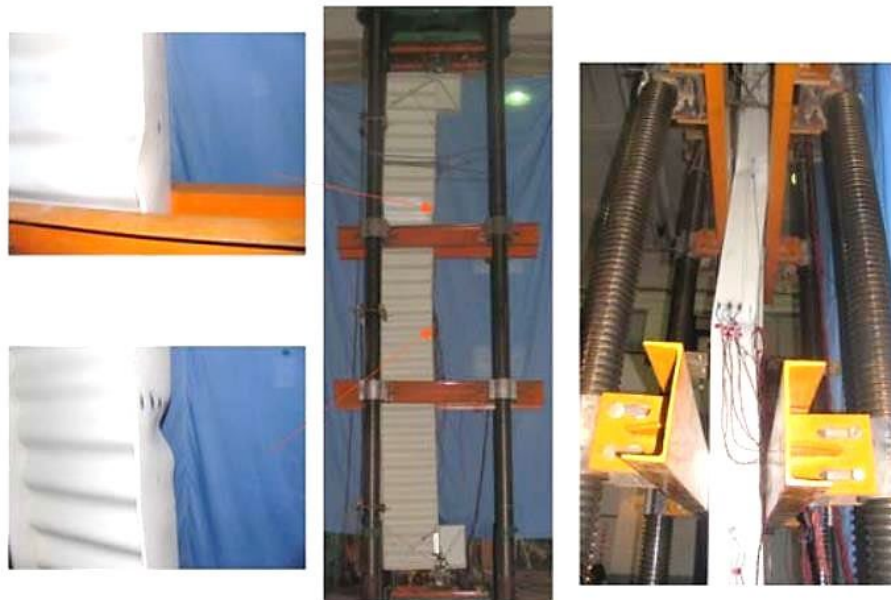
Рис. 2.7. Експериментальні випробування стержнів з поперечно гофрованою стінкою синусоїдального профілю, при дії згину і стиску [21]
