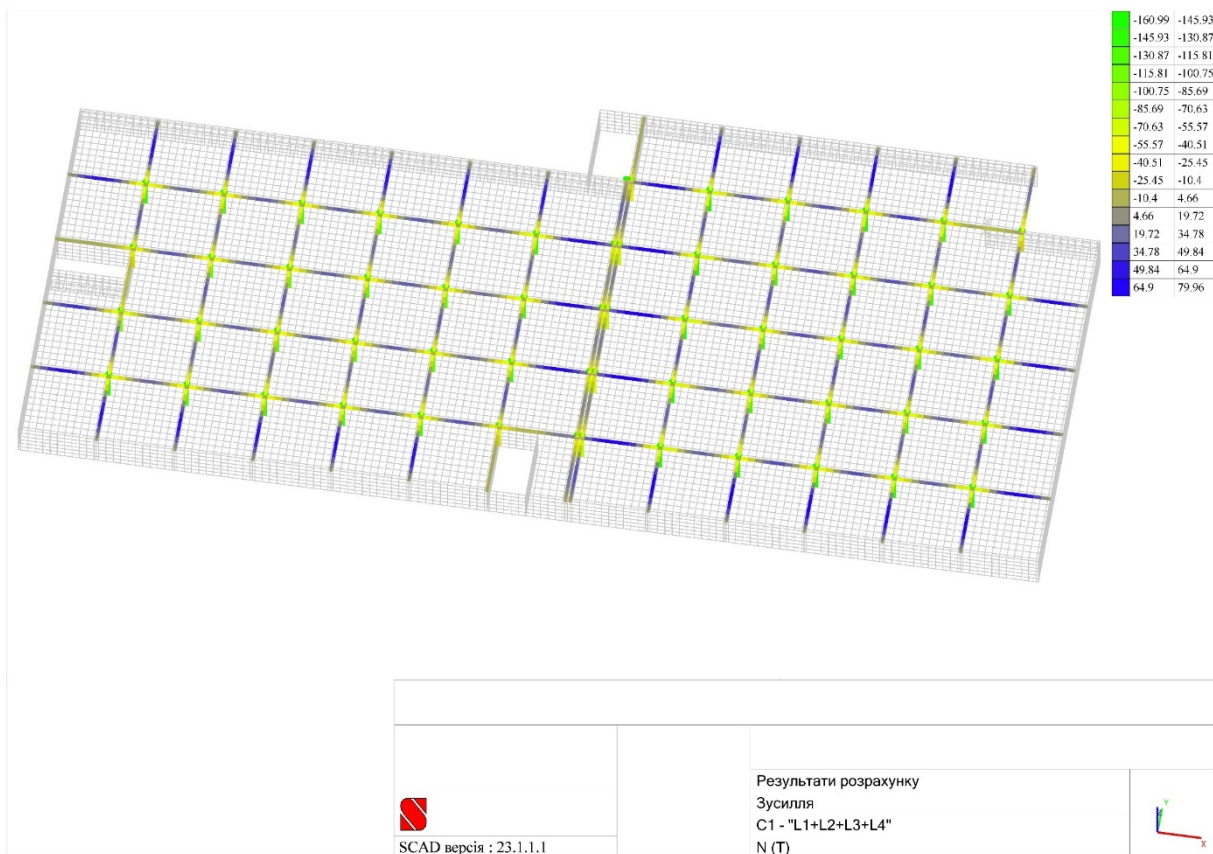
Рис.2.29. Схема перекриття із зазначенням величин поздовжньої сили N в балках
