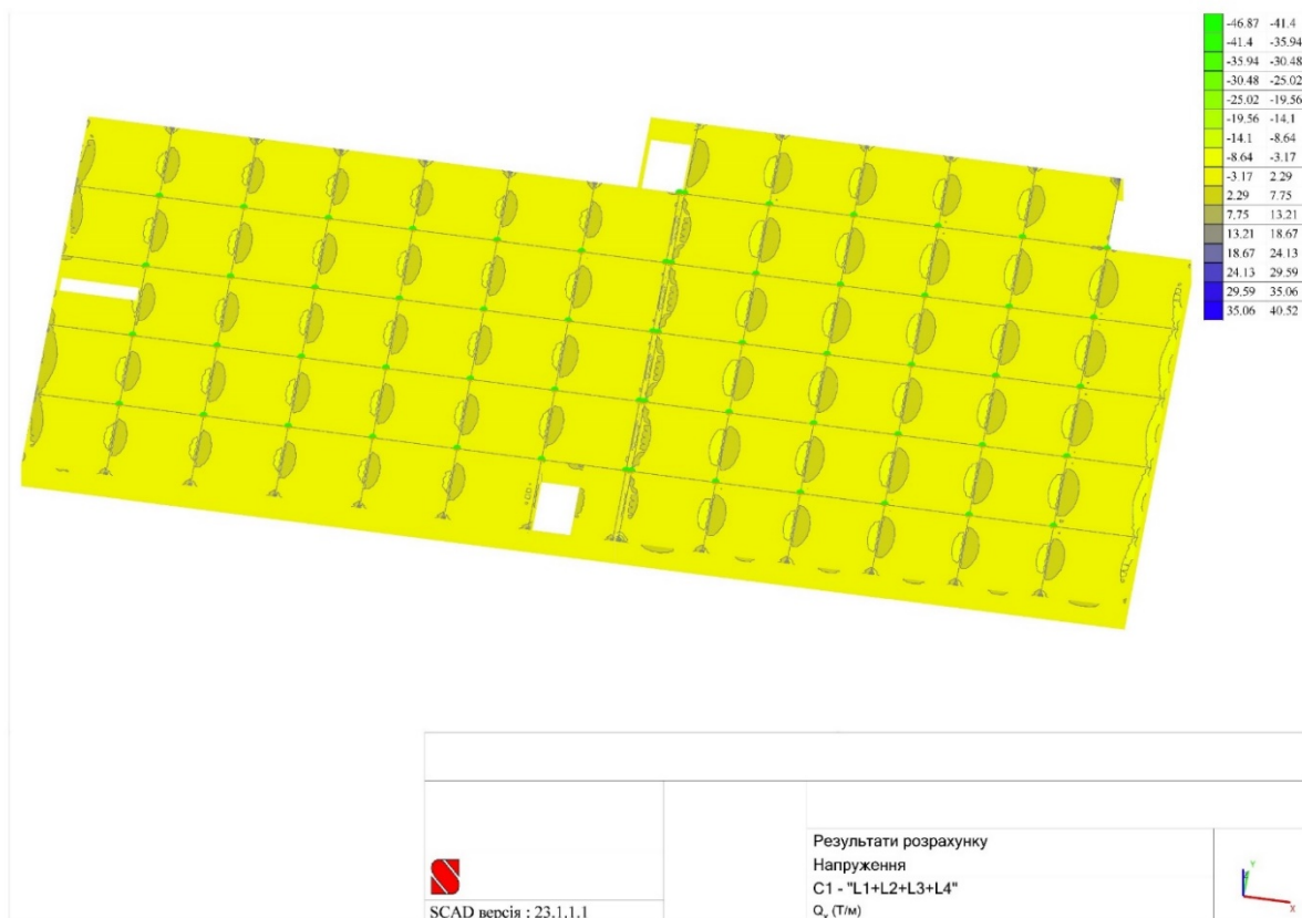
Рис.2.27. Схема перекриття із зазначенням величин зусиль поперечної сили Q_x відносно осі X
