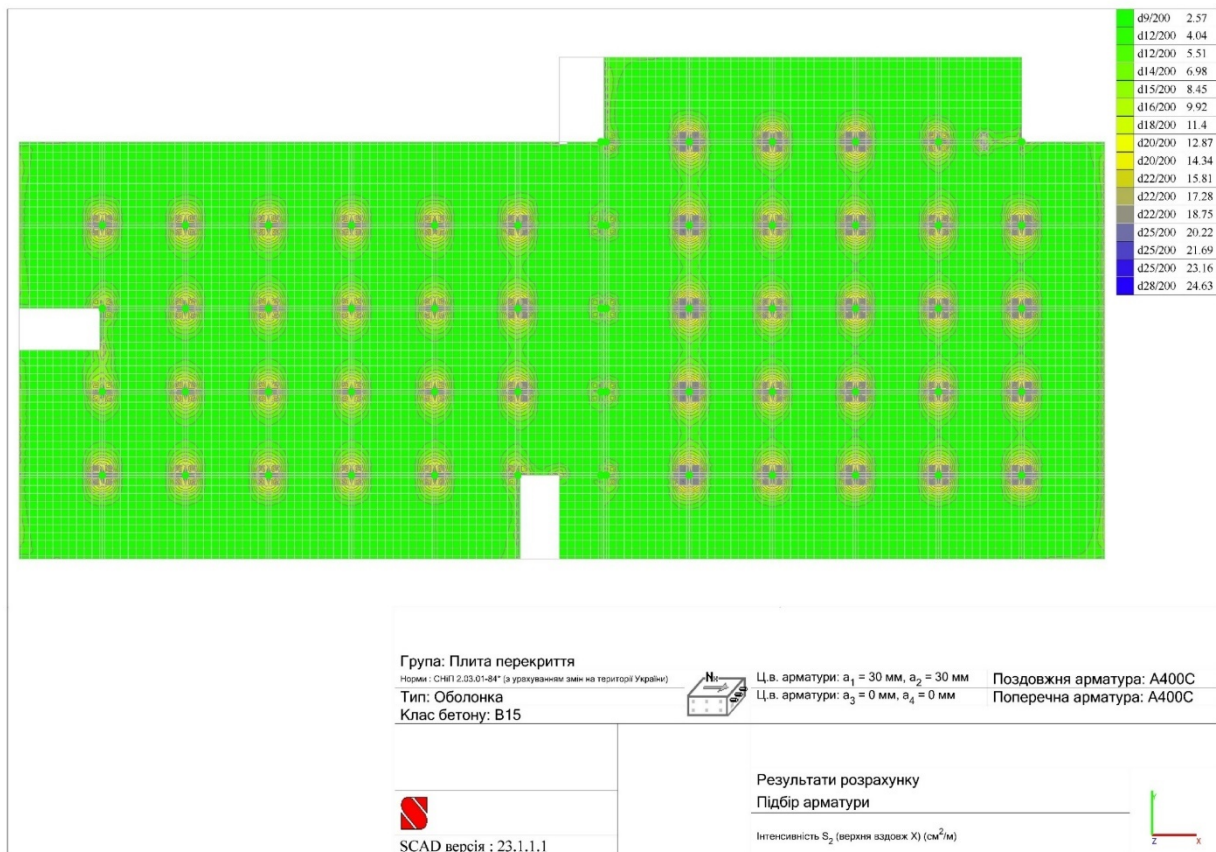
Рис.2.22. Схема перекриття із зазначенням інтенсивності армування верхньої зони плити вздовж осі X
