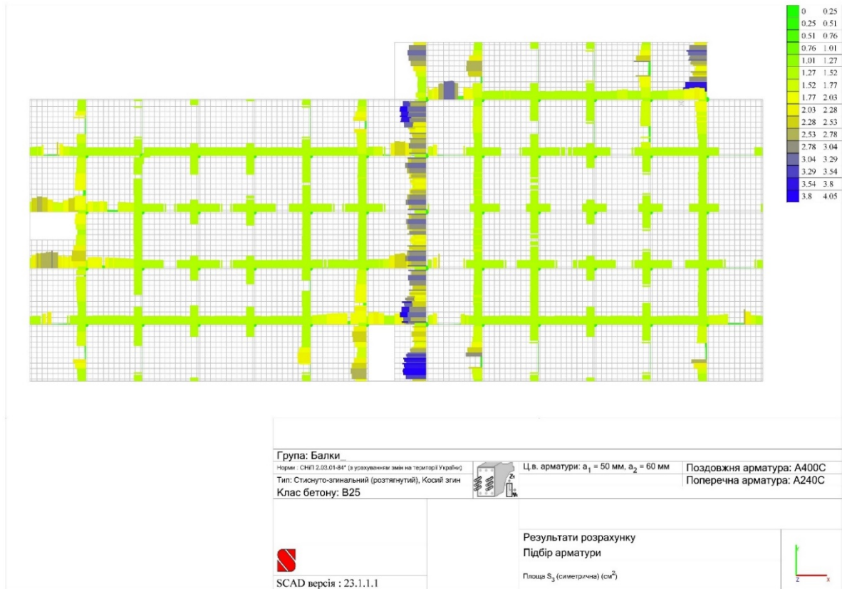
Рис.2.40. Схема перекриття із зазначенням інтенсивності армування бокових зон балок
