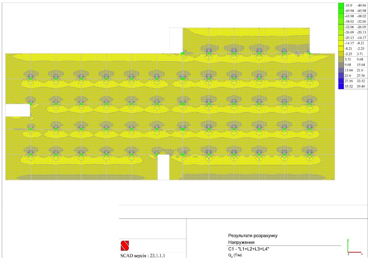
Рис.2.18. Схема перекриття із зазначенням величин зусиль поперечної сили Q_y відносно осі Y
