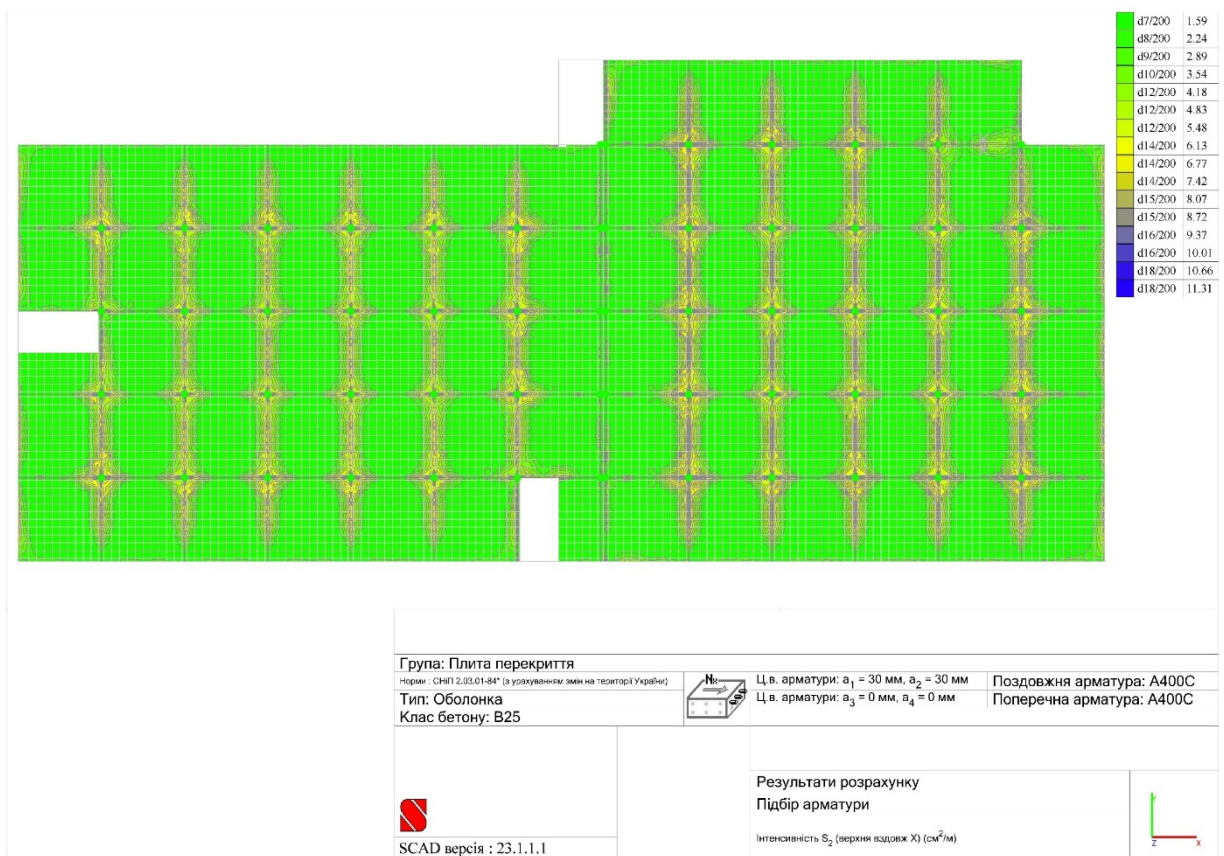
Рис.2.37. Схема перекриття із зазначенням інтенсивності армування верхньої зони плити вздовж осі X
