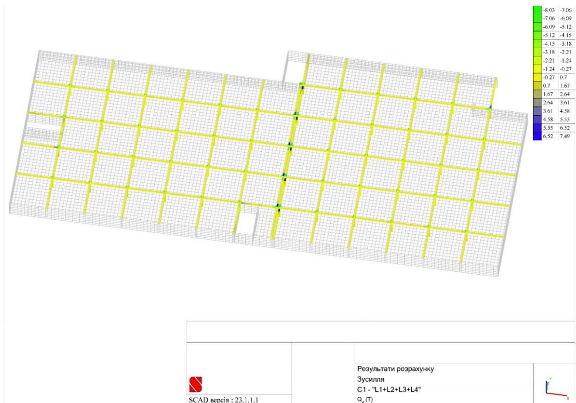
Рис.2.31. Схема перекриття із зазначенням величин згинальних моментів M_z відносно осі Z в балках
