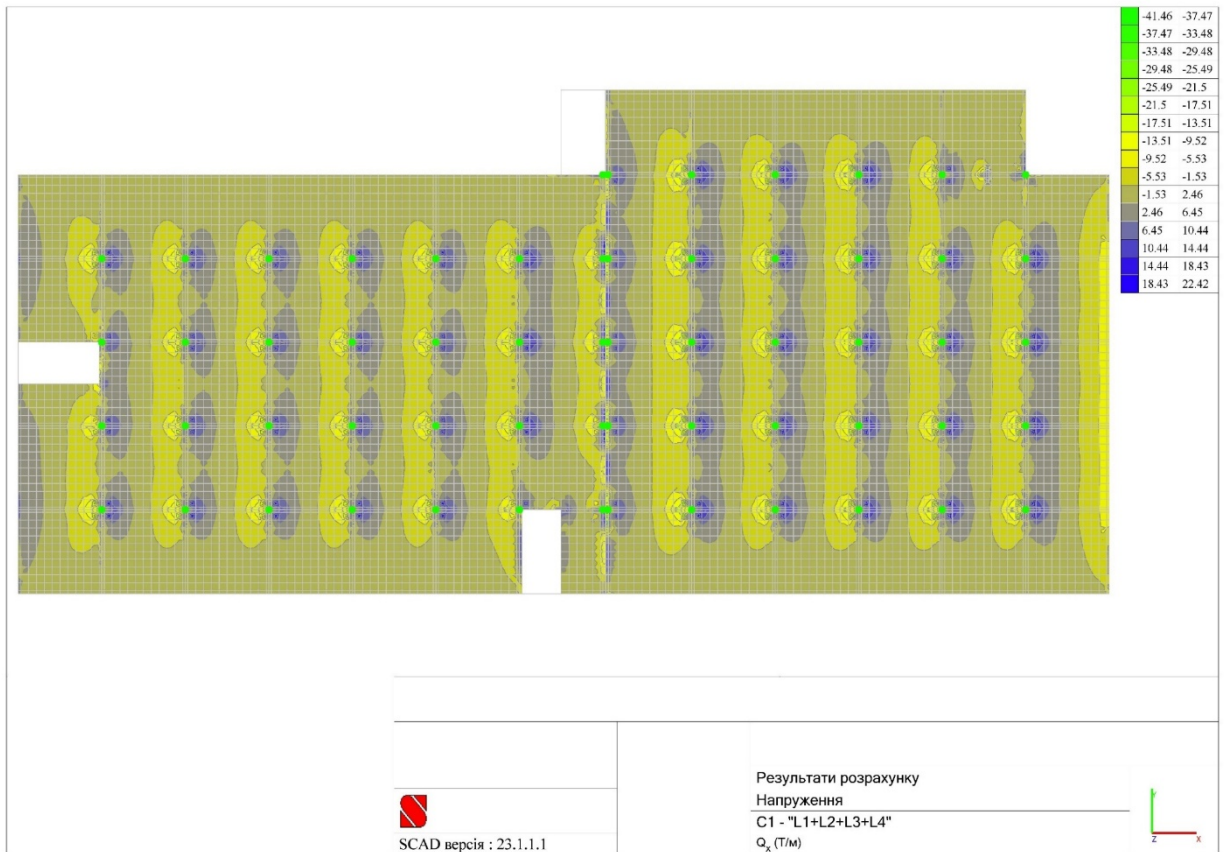
Рис.2.16. Схема перекриття із зазначенням величин згинальних моментів M_{xy} відносно осей X та Y
