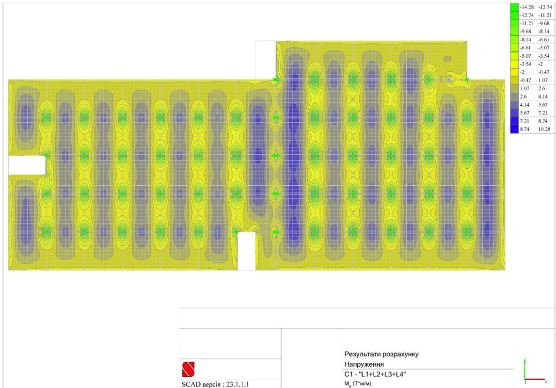
Рис.2.14. Схема перекриття із зазначенням величин згинальних моментів M_x відносно осі X
