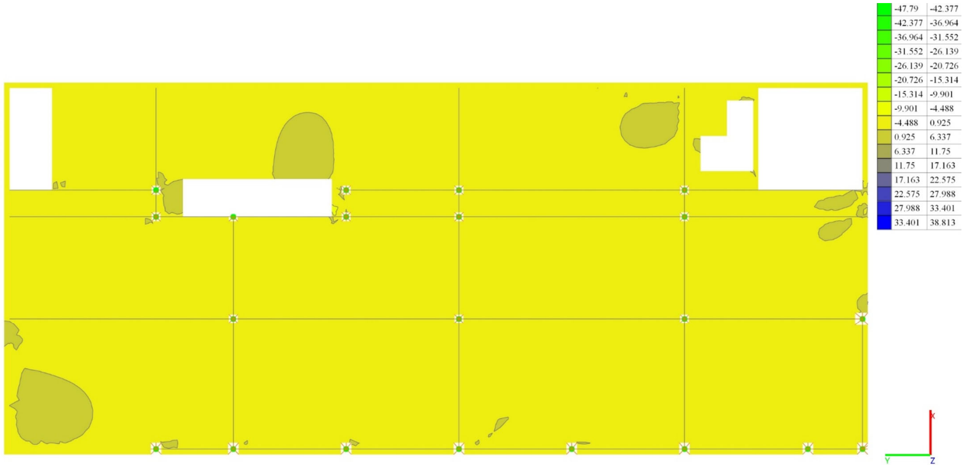
Рисунок 2.3.47. Схема перекриття над 1-м поверхом із зазначенням величин згинальних моментів M_{xy} відносно осі X та Y
