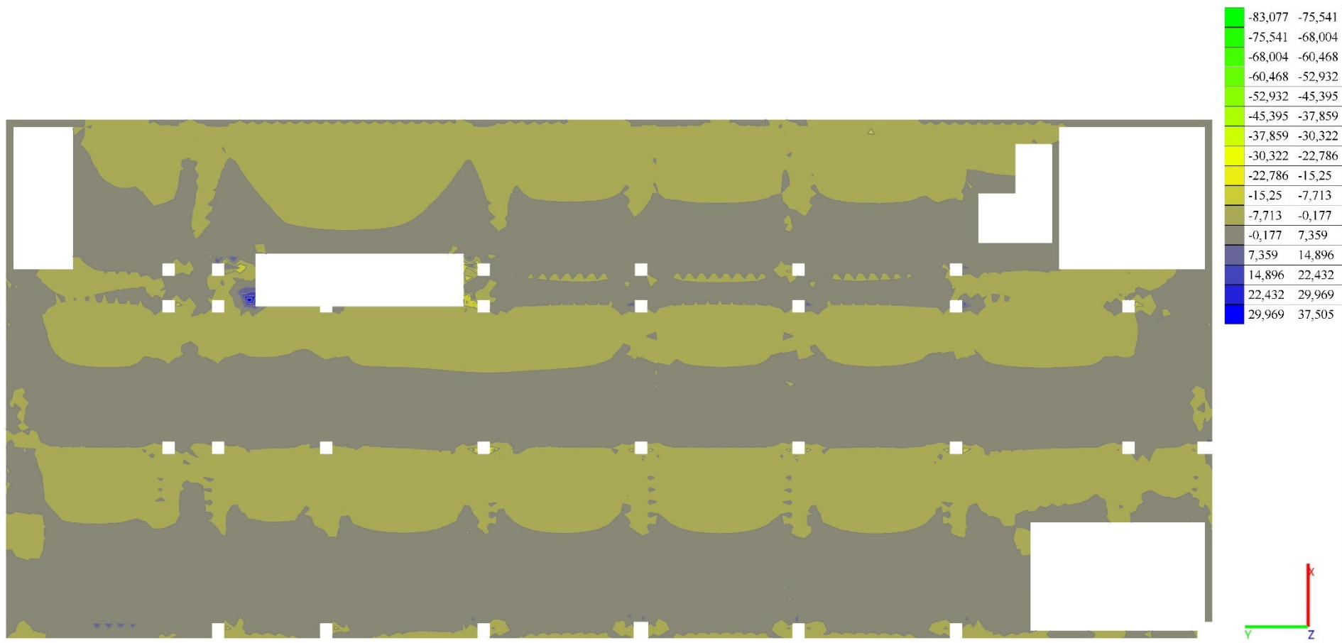
Рисунок 2.3.19. Схема перекриття над підвалом із зазначенням величин зусиль поперечної сили Q_x відносно осі X
