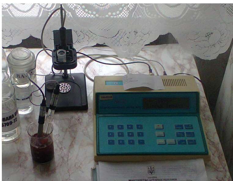
Рис. 3.1 Прилад Іономер рХ-150.1МІ
