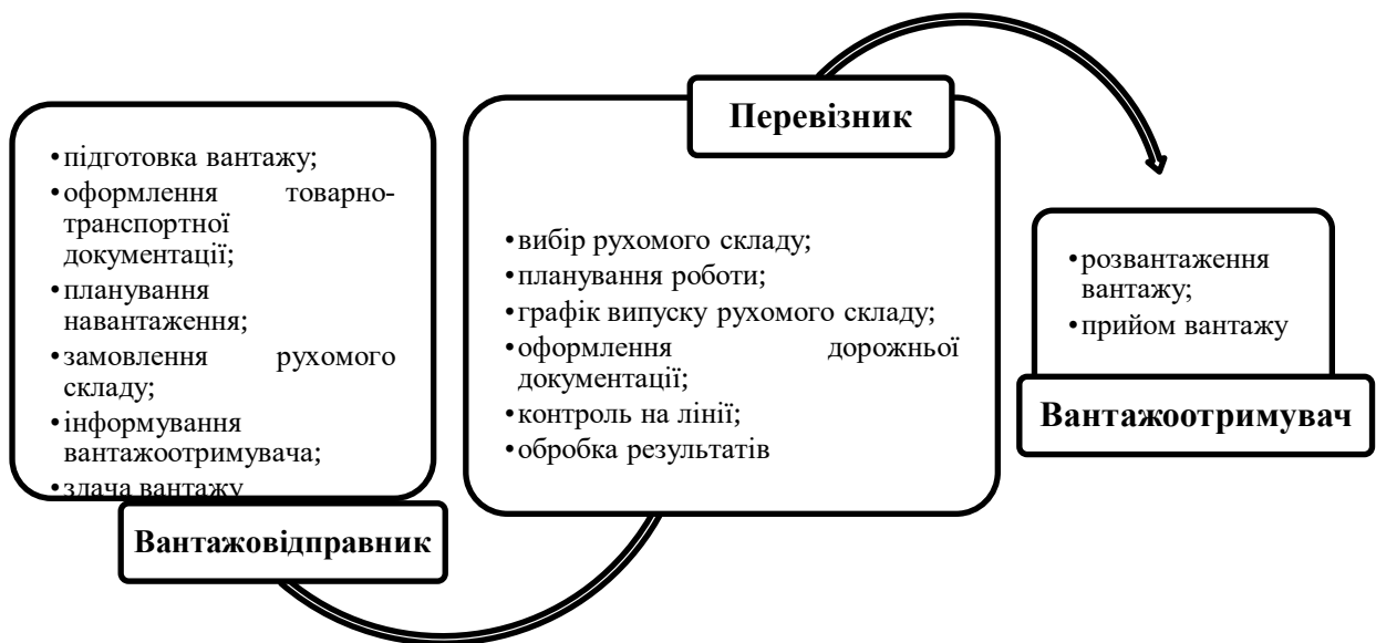
Рис. 2.4 - Розподіл технологічного процесу перевезення вантажів
