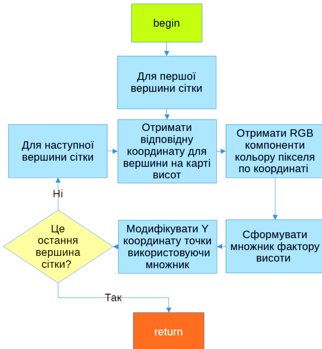
Рисунок 2.2 – Блок-схема алгоритму генерації мешів
