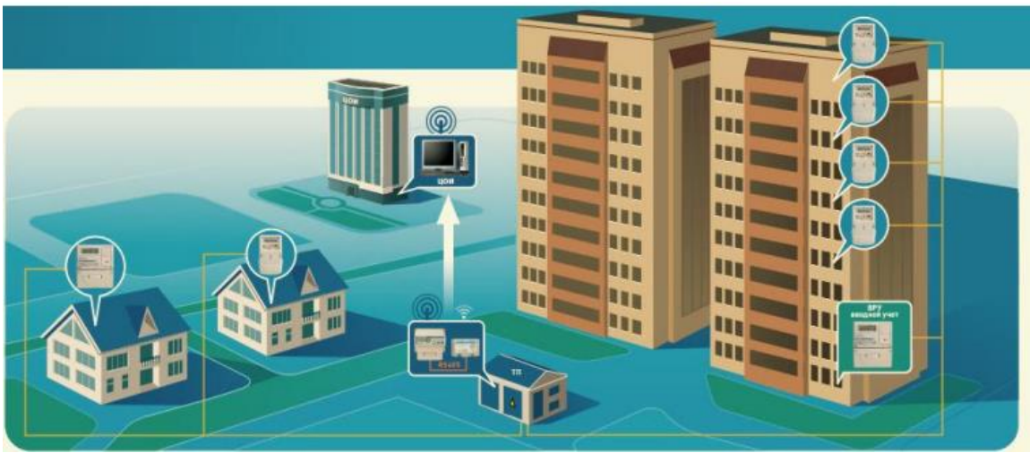
Рисунок 3.2 – Система організована з використанням PLC передачі
