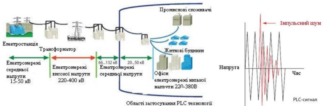
Рисунок 3.4 – Основні межі застосування PLC системи та особливості реалізації сигналів
