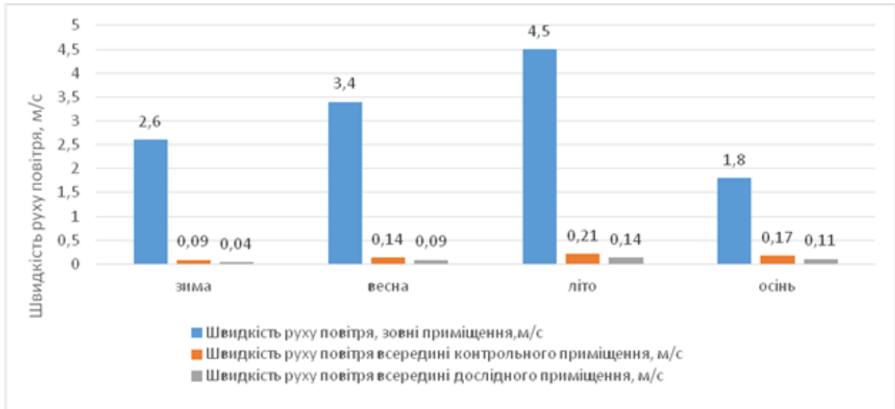
Рис. 6.7. Динаміка змін швидкості руху повітря всередині приміщення залежно від сили вітру зовні приміщення
