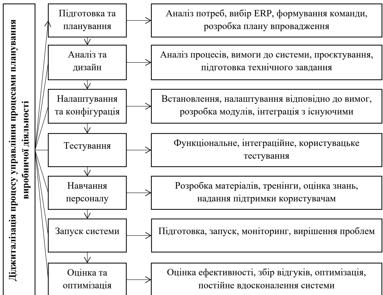
Рисунок 3.1 - Етапи планування та впровадження ERP системи у Філії «ВКВК» ТОВ «Вінницька птахофабрика»
