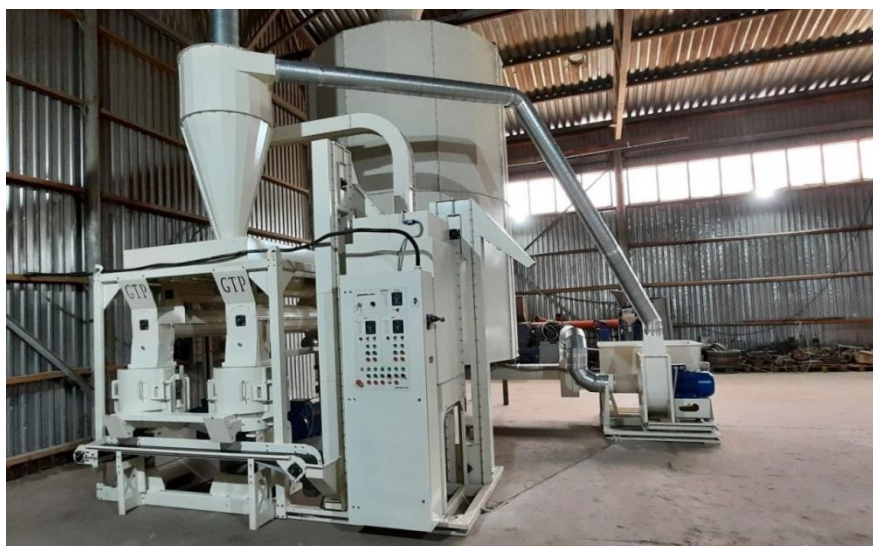
Рисунок 3.4 – Гранулятор із плоскою матрицею ГК Біоекопром
