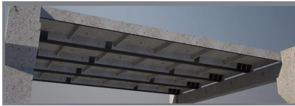
Рис. 5.1 Покриття промбудівлі із залізобетонних ребристих плит
