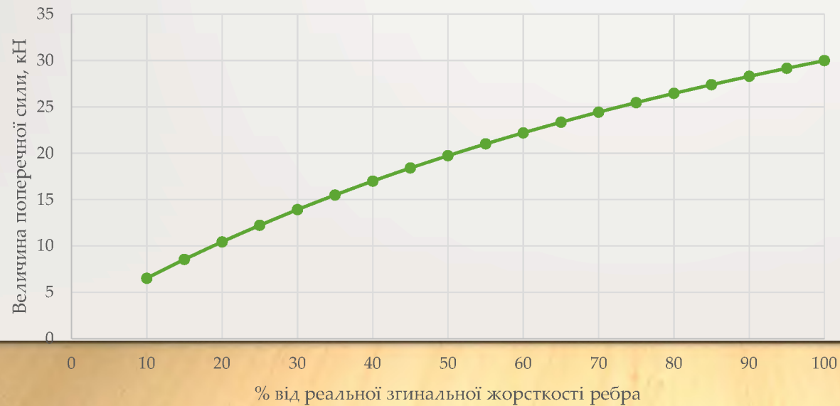
Залежність поперечної сили від жорсткості ребра (IV-те ребро)
