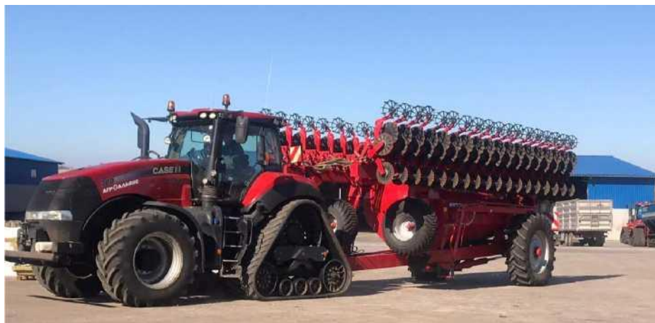
Рисунок 1.1 – МТА на базі трактору Case MX 380, споряджений сівалкою для точного висіву Horchsh Maestro 36.5
