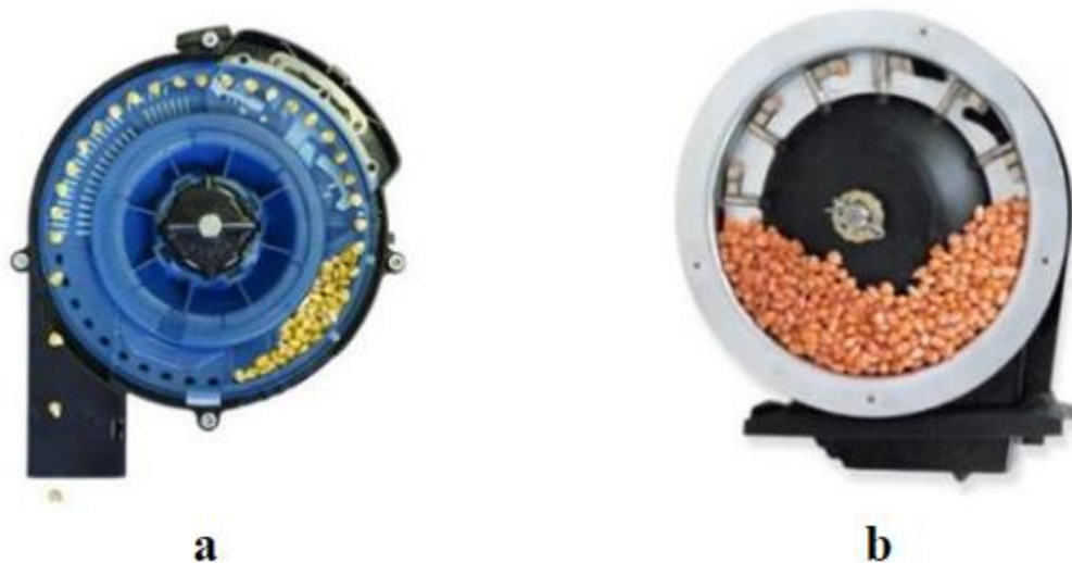
Рис. 2 - Два типи системи дозування насіння. Вакуум (а) і пальцевий знімач (b)
