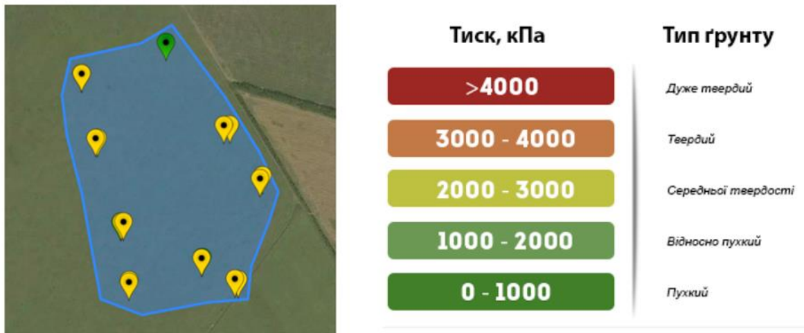
Рисунок 2.2 – Залежності твердості і щільності ґрунту
