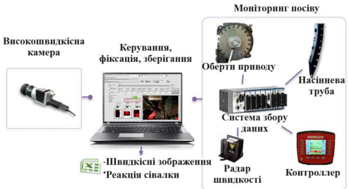
Рис. 5 - Потік даних від камери та системи DAS до комп'ютера
