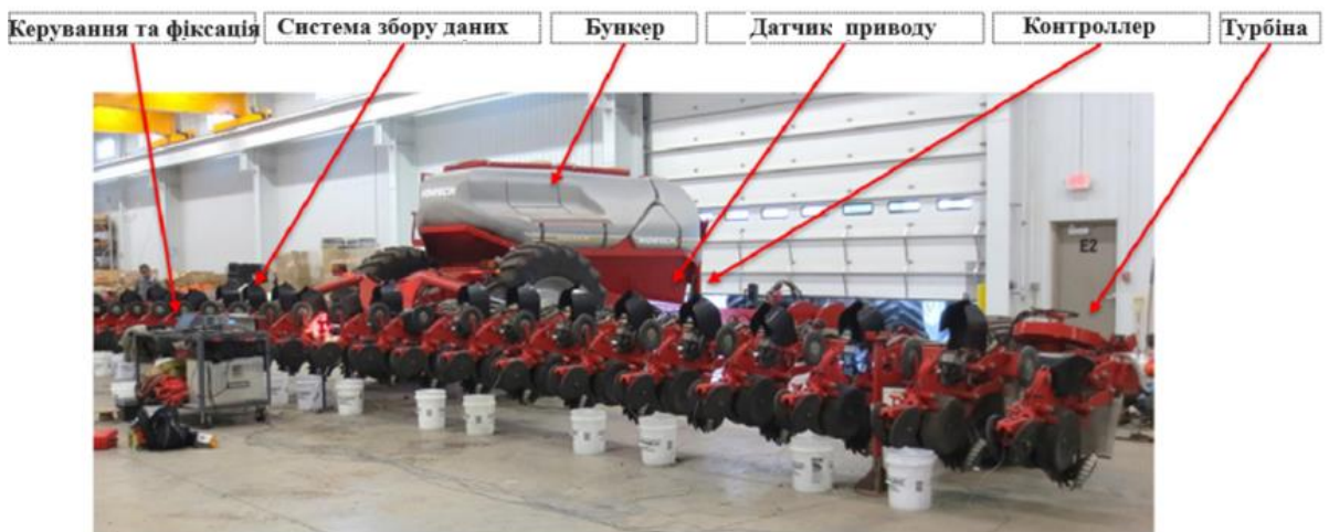
Рис. 1 - Конфігурація сівалки для збору даних насінневої трубки, швидкості висівного двигуна та високошвидкісного зображення (А)
