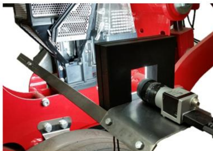
Рис. 6 - Висівний диск для кукурудзи з візуальними індикаторами щілин (А) і високошвидкісною камерою (В)
