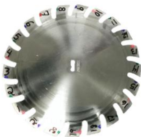
Рис. 6 - Висівний диск для кукурудзи з візуальними індикаторами щілин (А) і високошвидкісною камерою (В)
