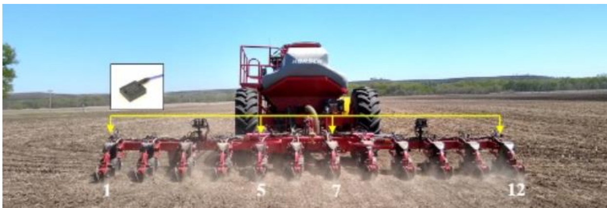
Рис. 3 – Висівні секції, на яких були встановлені акселерометри для вимірювання їх прискорення
