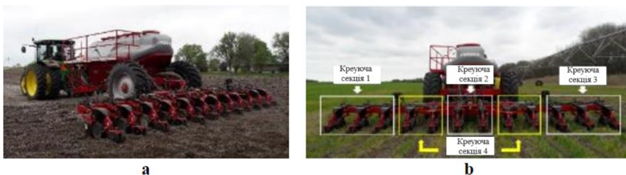
Рис. 2 - (а) Сівалка для просапних культур, використана в дослідженні, і (б) розподіл висівних секцій у контрольних секціях
