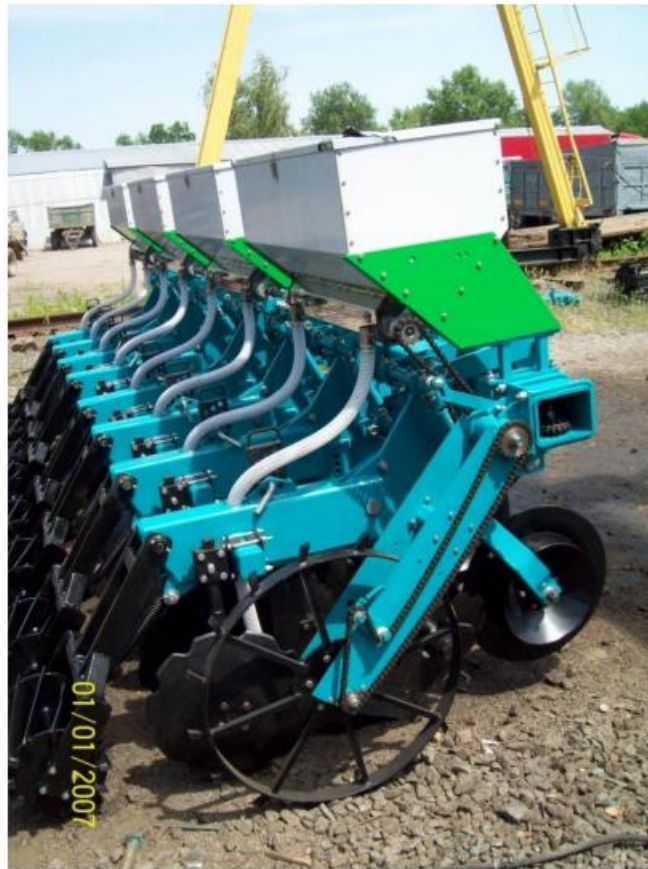
Рисунок 1.6 – Комбінований агрегат смугового землеробства АСОГ-8 обладнаний механізмом внесення добрив.
