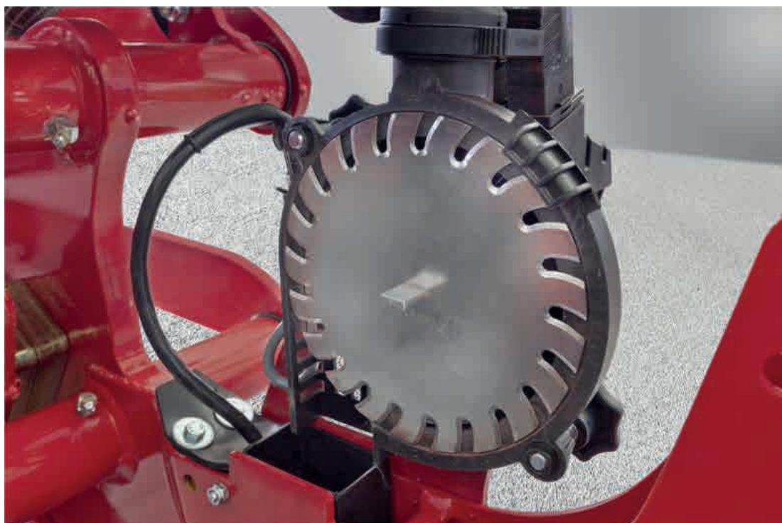
Рисунок 3.6 – Налаштування дозатора насіння сівалки HORSCH Maestro для висіву кукурудзи
