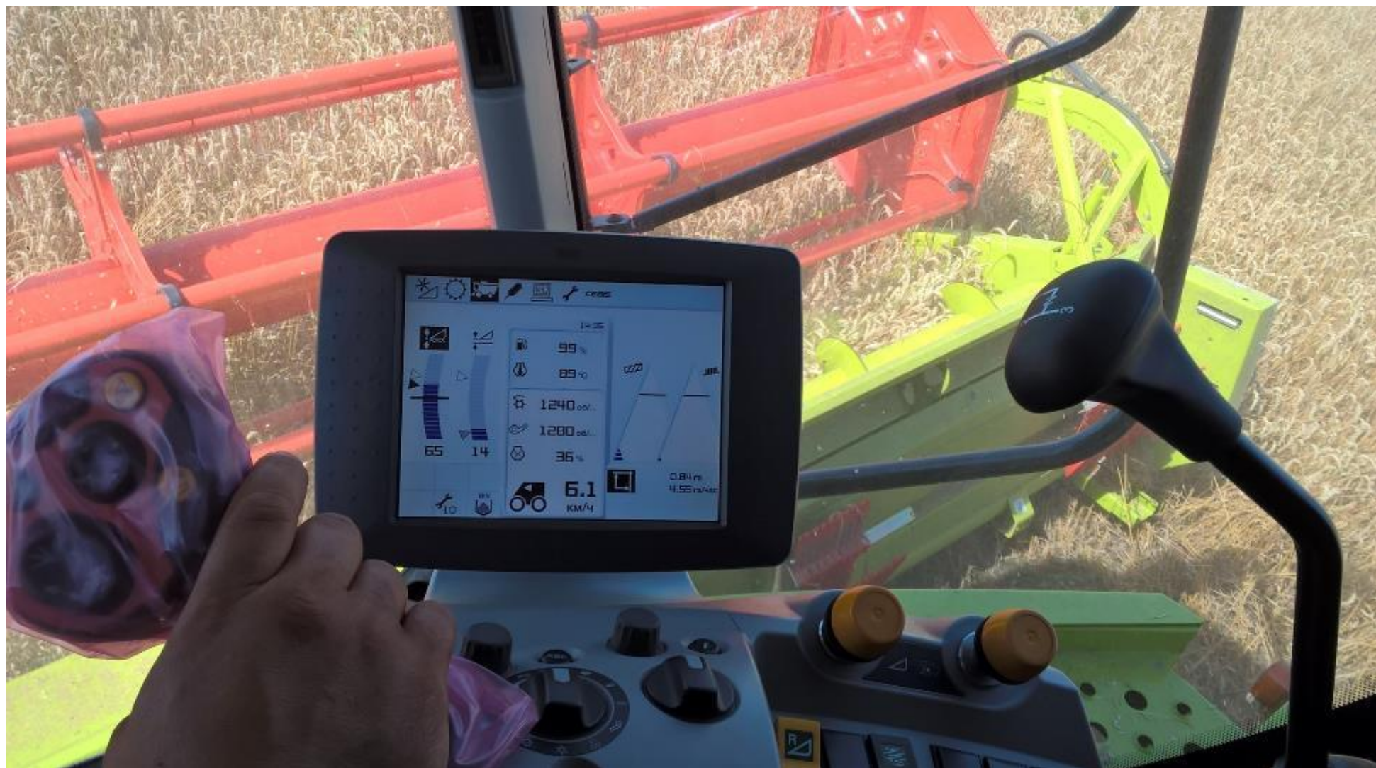
Рисунок 4.12 – Загальні показники роботи комбайну при використанні автоматизованої системи CLAAS TELEMATICS Pro в процесі досліджень
