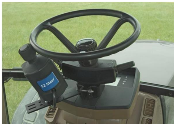
Рисунок 1.5 – Підрулюючий пристрій Trimble AgGPS EZ-Steer
