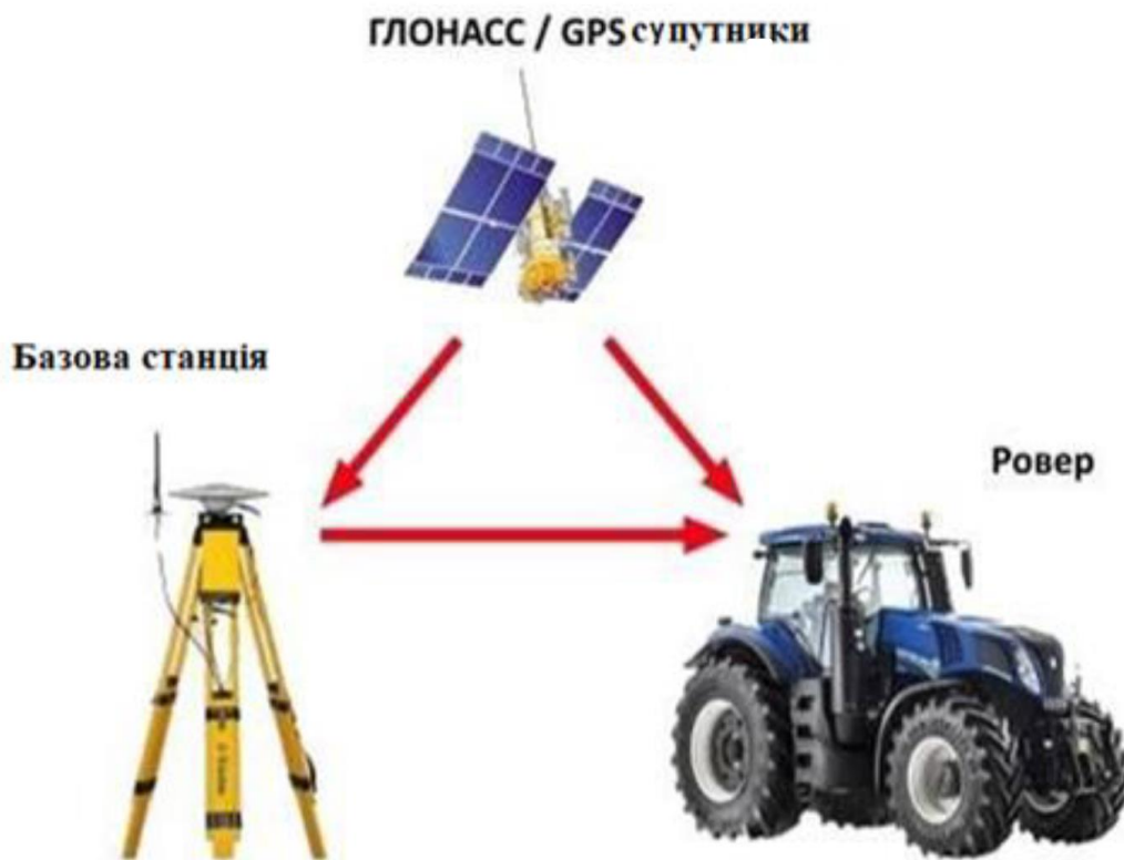
Рисунок 1.7 – Принцип роботи в режимі RTK
