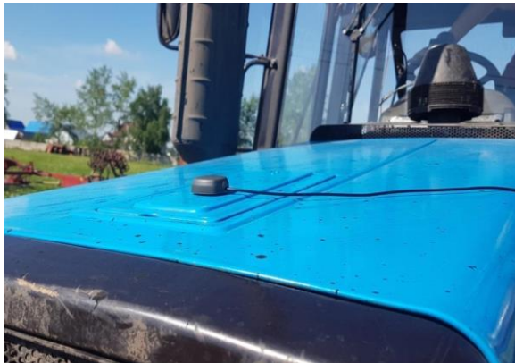
Рисунок 3.12 – Кріплення антени GNSS-приймача
