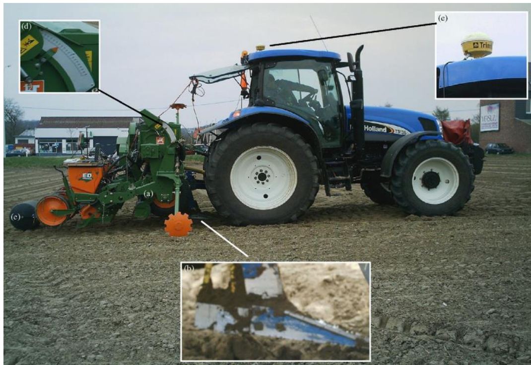
Рис. 2 – Система для внесення фосфору зі змінною нормою на основі датчика ґрунту, використана у дослідженні; (а) сівалка та аплікатор для внесення добрив (AMAZONE, ED332); (b) датчик і глибокорозпушувач; (с) антена DGPS; (d) електричний привід і (е) колесо для закриття борозни, зробленої глибокорозпушувачем
