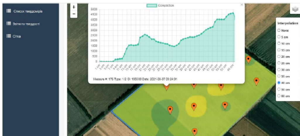
Рисунок 3.6 - Типова крива твердості ґрунту: з глибини 37 см спостерігається стабільне зростання твердості
