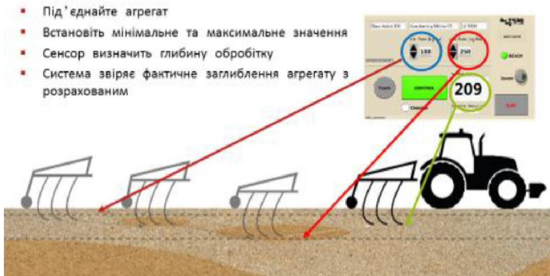
Рисунок 3.13 - Схема налаштування агрегату на диференційований обробіток ґрунту
