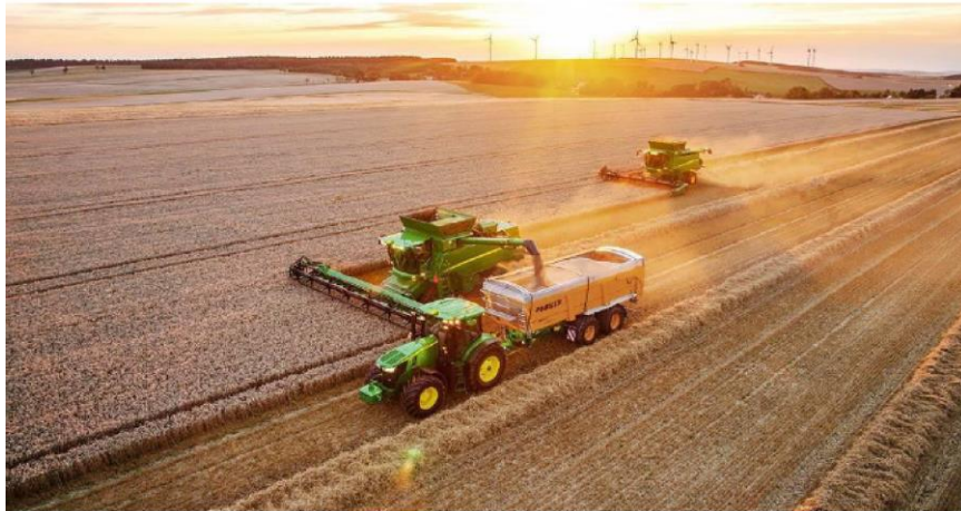
Рисунок 2.5 - Приклад використання системи AMS зі стандартом ISOBUS при вивантаженні зерна з синхронізацією швидкості агрегатів
