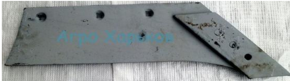
Рисунок 1.6–Долотоподібний суцільно кований лемеш
