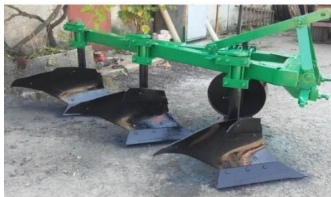
Рисунок 1.15 – Загальний вид плуга з комбінованою полицею БПЛ-3-35
