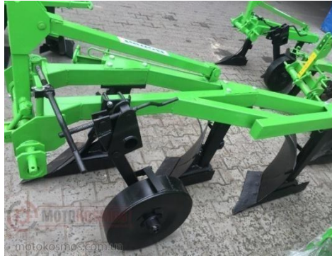
Рисунок 1.11 – Плоска полиця плуга Vomet
