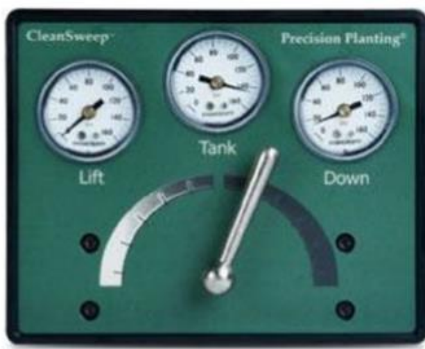
Рис. 2. Система регулювання притискового зусилля системи CleanSweep
