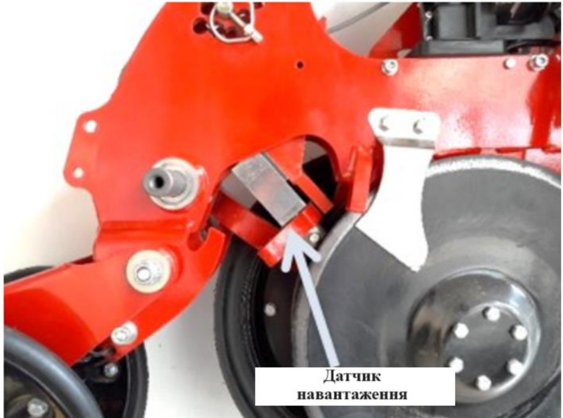
Рис. 2 - Датчик навантаження, встановлений на кулачковому вузлі, розміщеному поперек важелів коліс
