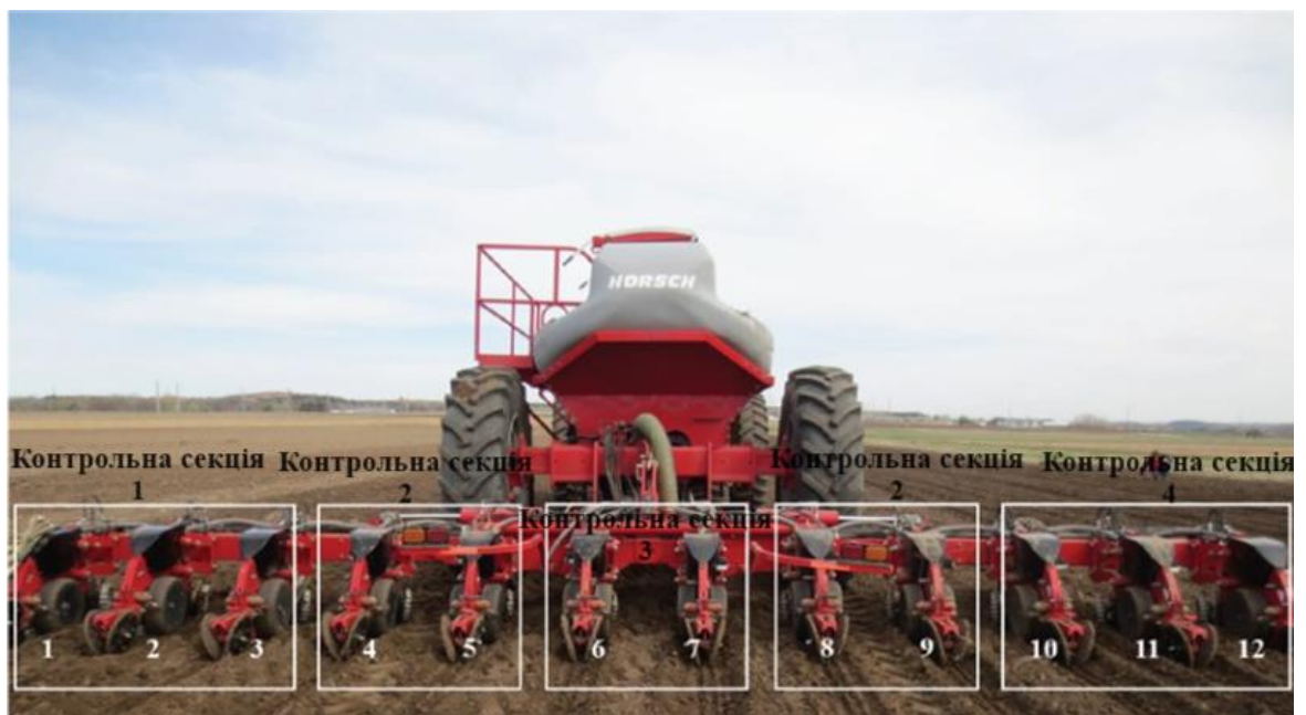
Рис. 1 - Робочі органи сівалки, що містить 12 рядків (висівних секцій), пронумерованих від 1 до 12 зліва направо, разом із секцією гідравлічного керування притисною силою
