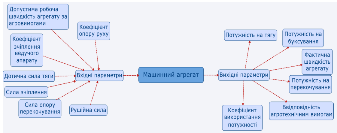
Рис. 7. Схема формування результатів аналізу техніко-економічних показників роботи машинних агрегатів
