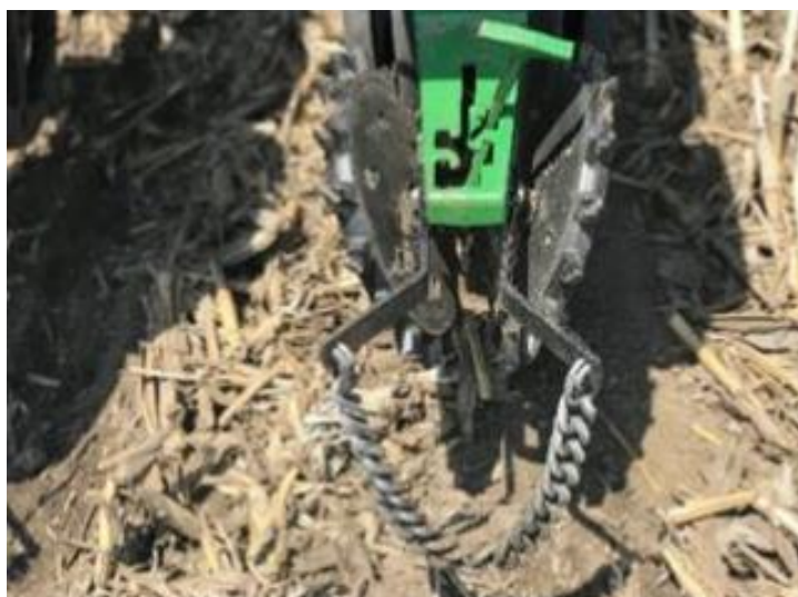
Рис. 15. Спарені пластикові зубчасті прикочувальні колеса Twister
