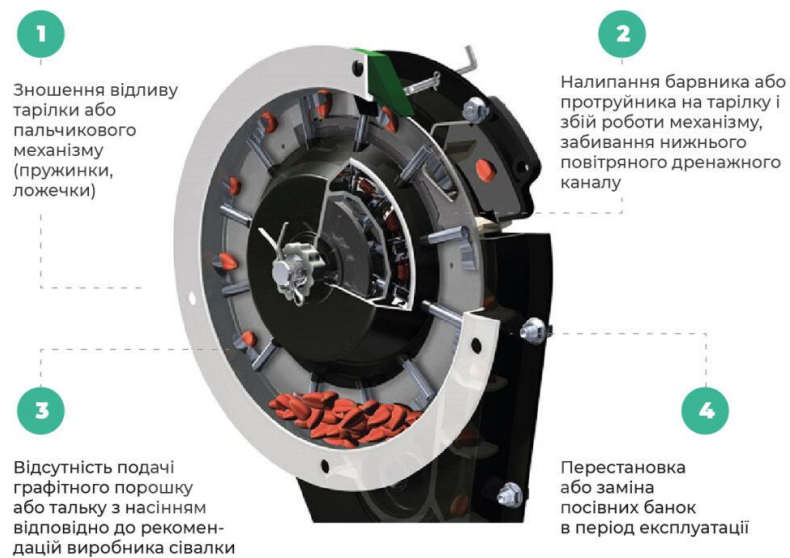
Рис. 2. Висівний апарат сівалки для висіву просапних культур
