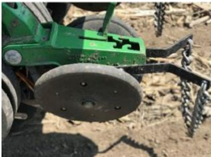
Рис. 14. Спарені прикочувальні колеса з гладким гумовим бандажем
