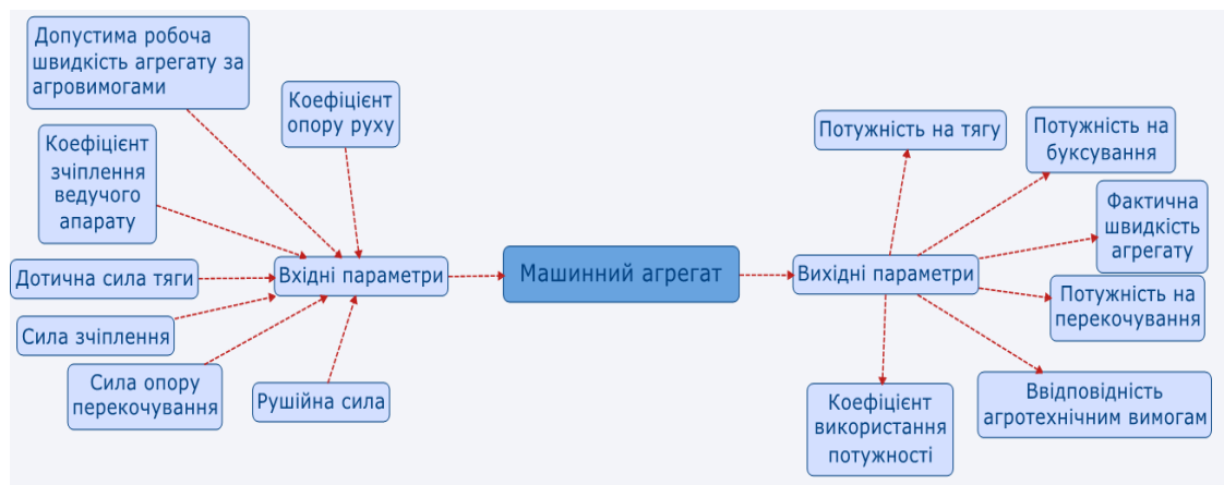
Рис. 8. Схема формування результатів аналізу техніко-економічних показників роботи машинних агрегатів
