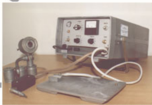
Рисунок 2.4 – Установки «ЕЛЛ-8А» (а) та «Елітрон-22А» (б), призначені для чистового легування
