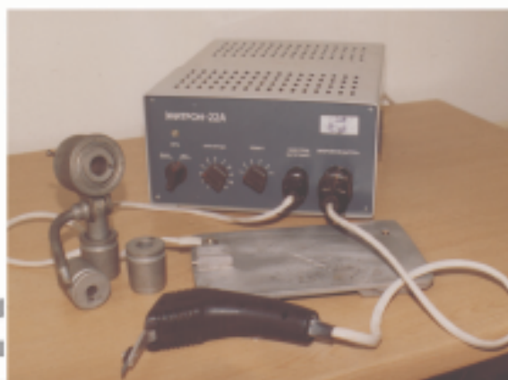
Рисунок 2.4 – Установки «ЕЛЛ-8А» (а) та «Елітрон-22А» (б), призначені для чистового легування
