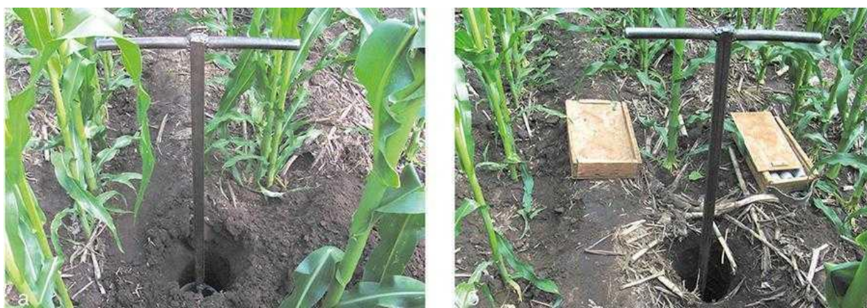
Рис. 3. Відбір проб на вологість ґрунту в шарах 0–40 см на обробітку Strip-till: а – не оброблена смуга; б – оброблена смуга (критичний період – фаза стеблуння)
