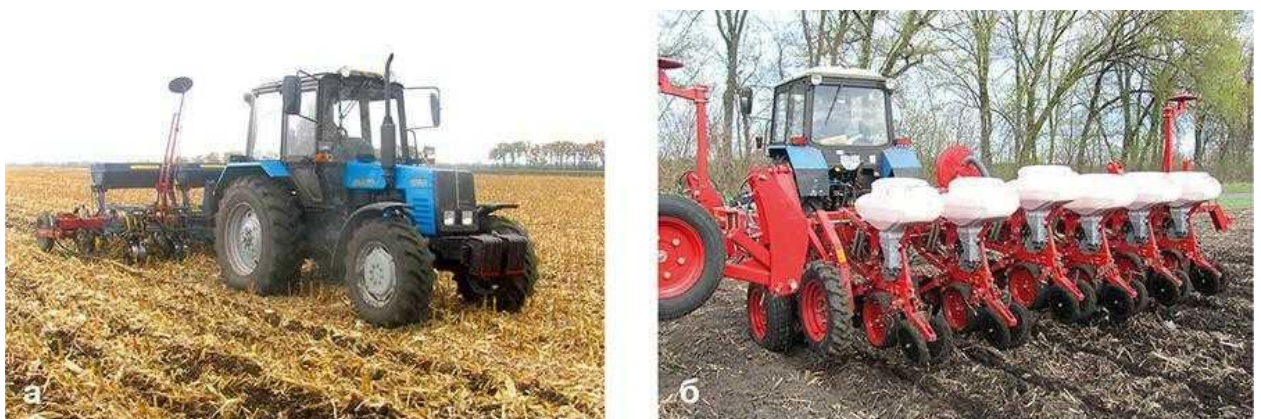
Рис. 1. Комплекс машин для вирощування культур за смуговим обробітком ґрунту: а – агрегат для нарізання смуг з одночасним внесенням мінеральних добрив СТА-4; б – просапна сівалка ВЕГА-8 з висівними секціями, дообладнаними блоком зірочок для роботи в умовах високого вмісту рослинних решток
