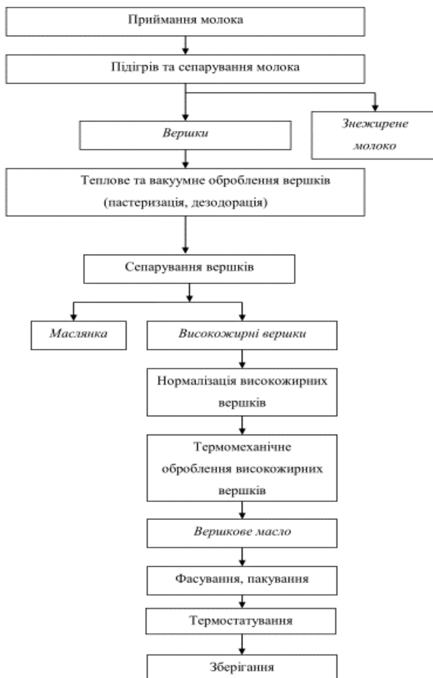
Рисунок 3.1 –Переробка молока сирого при отриманні вершкового масла та маслянки- апаратно-технологічна схема
