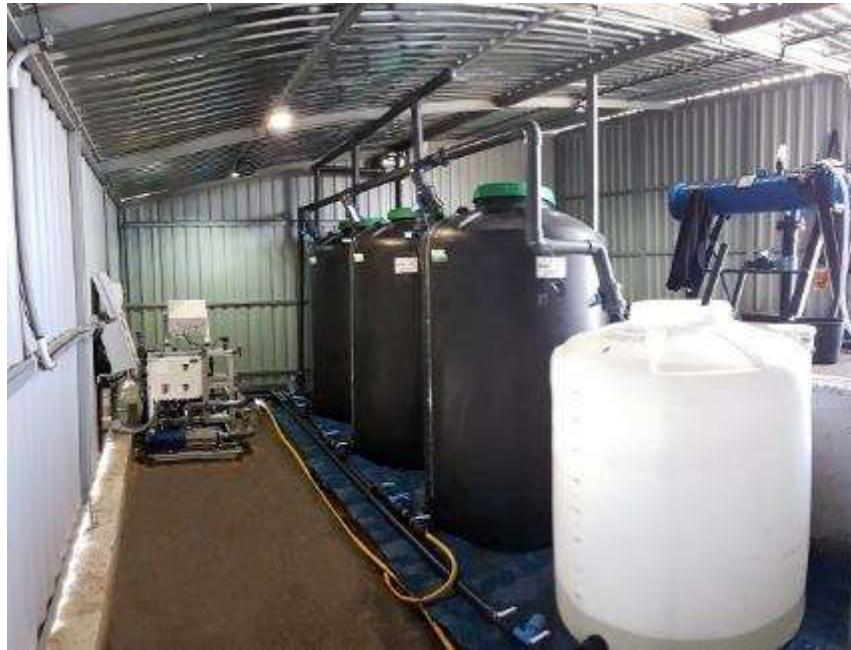
Рис. 1.7. Приклад фертигаційного вузла
