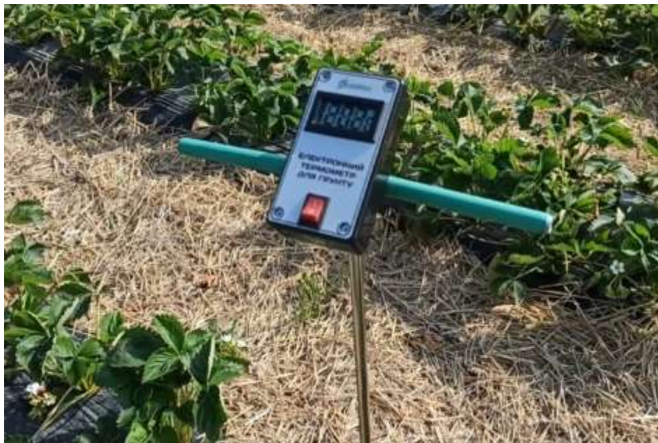
Рис. 2.3. Вимірювання температури ґрунту
