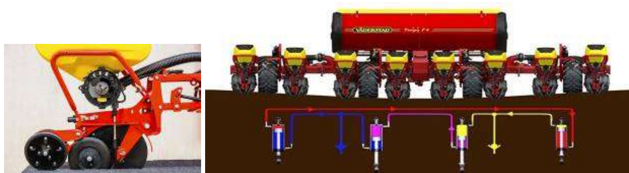
Рис. 2.9. Посівна секція та контроль притискання їх на полі
