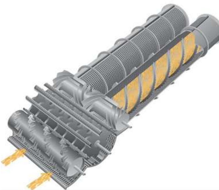
Рисунок 3.2. Система сепарації і обмолота комбайна Claas Lexion
